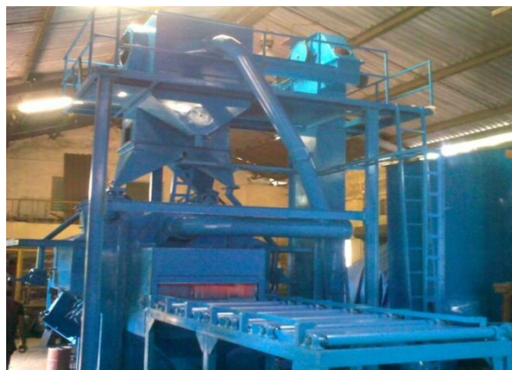
Slika 14. Oprema za automatsko pjeskarenje s konvejerom [17]
