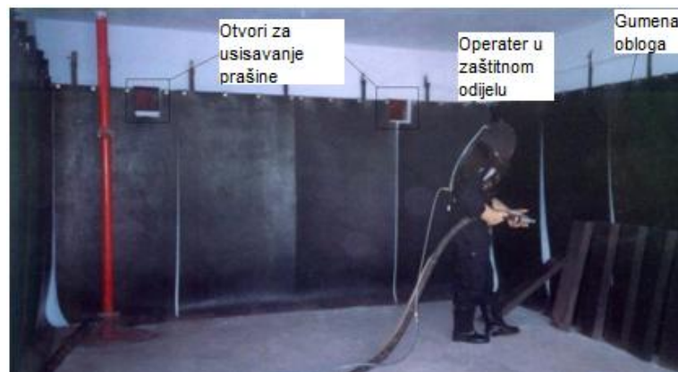
Slika 12. Pjeskarenje ručnom opremom u komori [17]
