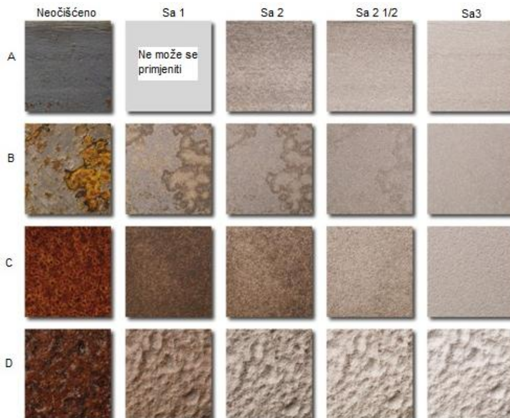
Slika 26. Stanje površine prije i nakon pripreme [24]
