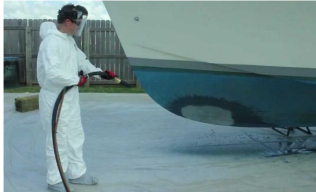
Slika 5. Čišćenje oplata broda mlazom abraziva [13]
