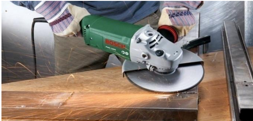
Slika 3. Brušenje zavarenog spoja [11]
