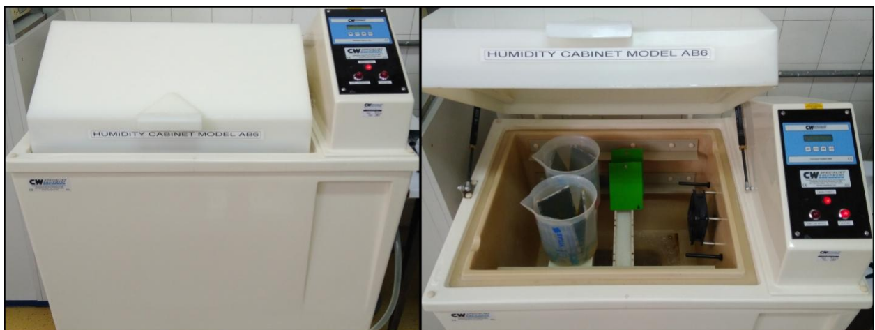
Slika 45. Vlažna komora „ CW AB6“, Laboratorij za zaštitu materijala, FSB, Zagreb
