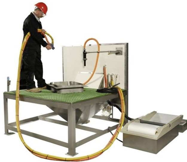
Slika 15. Oprema za mokro pjeskarenje [16]
