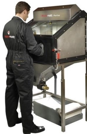
Slika 13. Prikaz pjeskarenja u ručnoj komori [16]
