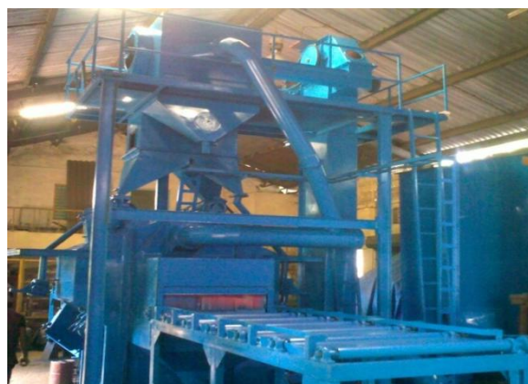
Slika 14. Oprema za automatsko pjeskarenje s konvejerom [17]
