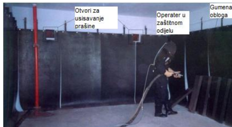
Slika 12. Pjeskarenje ručnom opremom u komori [17]
