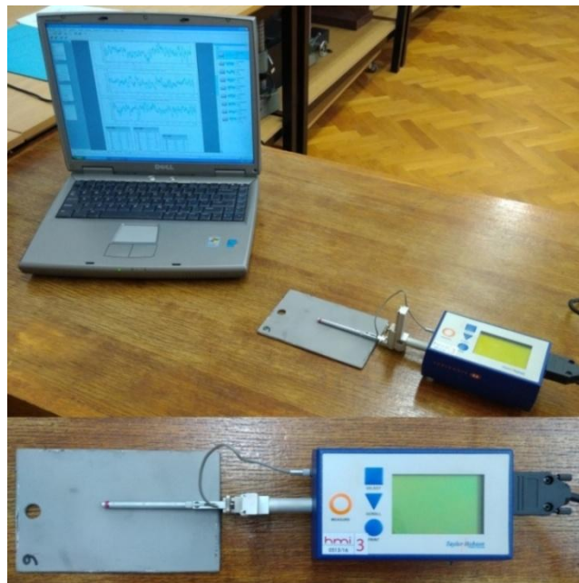
Slika 39. Uređaj „Taylor Hobson Surtronic 25“, Laboratorij za precizna mjerenja dužina, FSB, Zagreb
