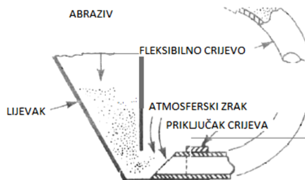
Slika 8. Priklijučak cijevi za dovod abraziva na lijevak s abrazivom [15]
