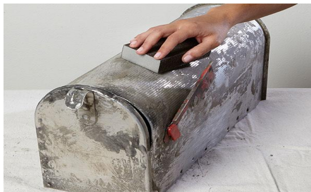
Slika 2. Ručno mehaničko čišćenje metalnog sandučića [10]
