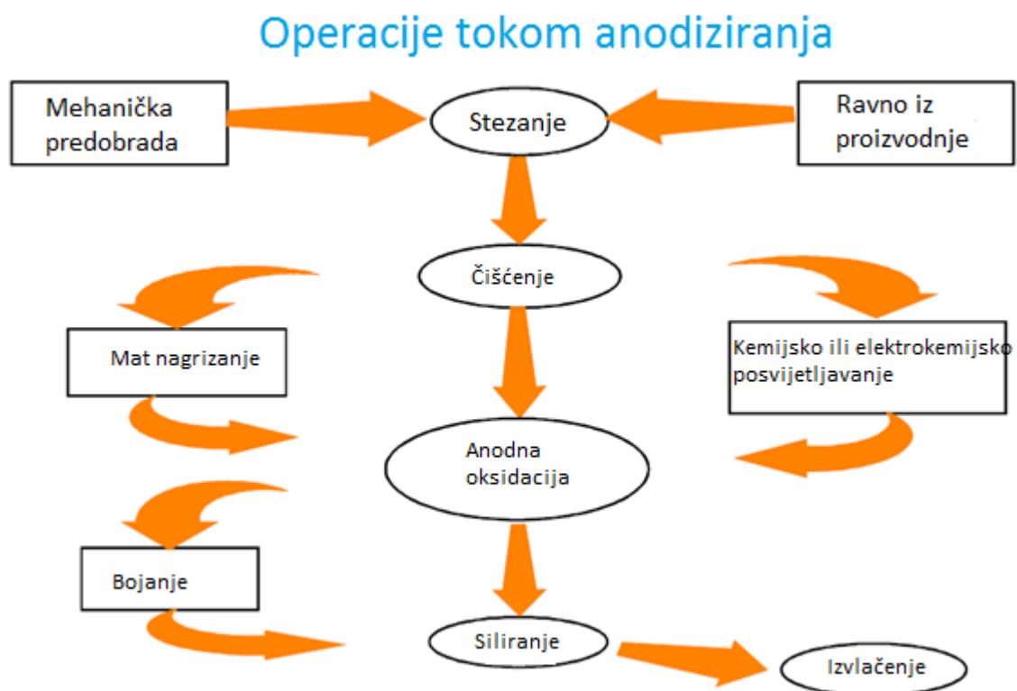
Slika 20. Operacije pri anodiziranju aluminija [32]
