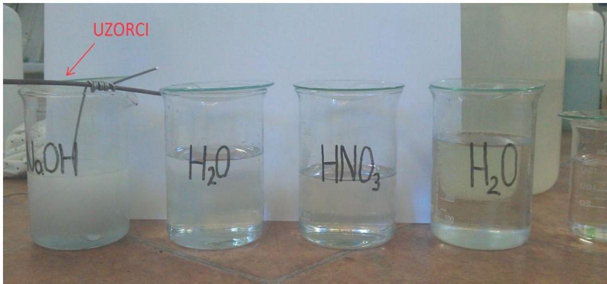
Slika 25. Kemijska obrada površine uranjanjem
