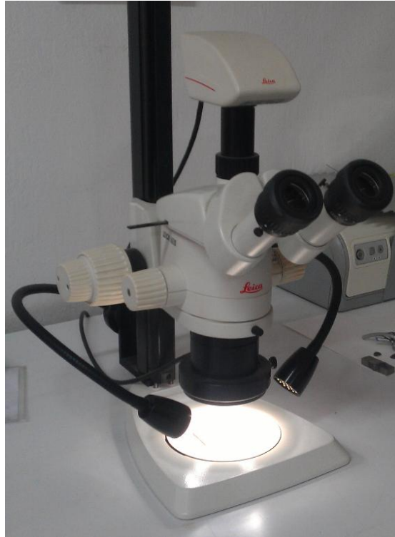
Slika 33. Stereomikroskop Leica MZ6
