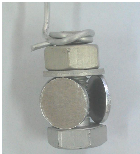
Slika 24. Uzorci stegnuti na vijku
