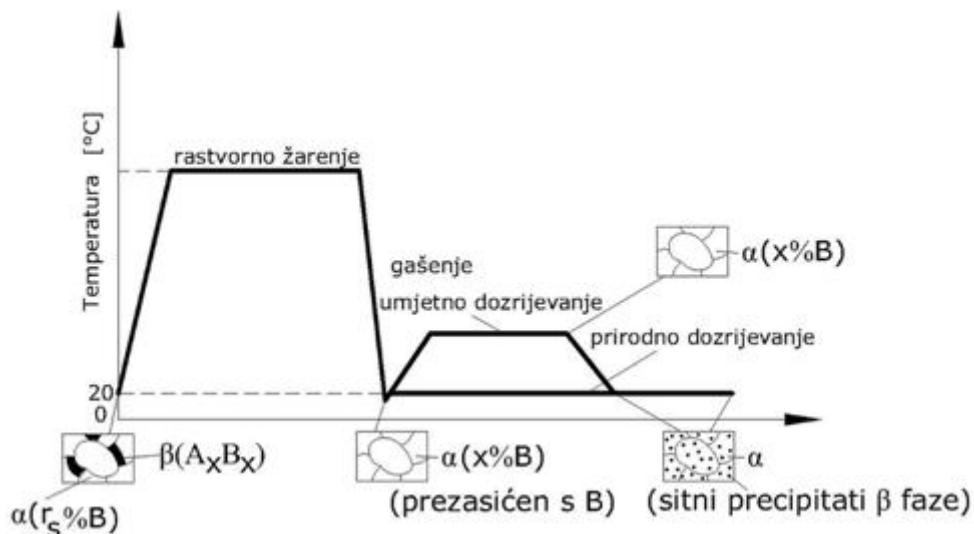
Slika 2. Postupak precipitacijskog očvrnsnoga [6]
