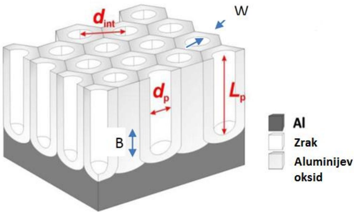
Slika 7. 3-D presjek poroznog sloja aluminijevog oksida [27]
