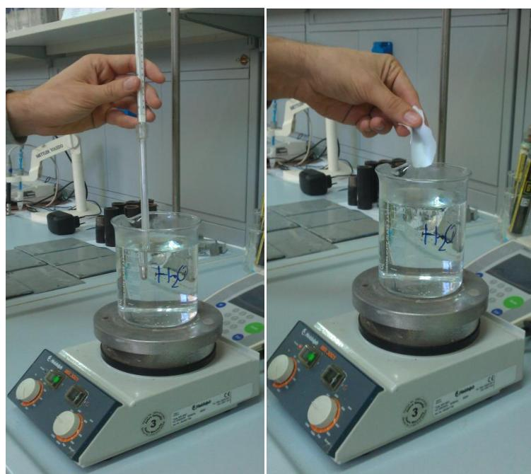
Slika 31. Priprema za siliranje uzorka
