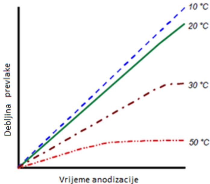
Slika 15. Utjecaj temperature elektrolita na debljinu prevlake [32]
