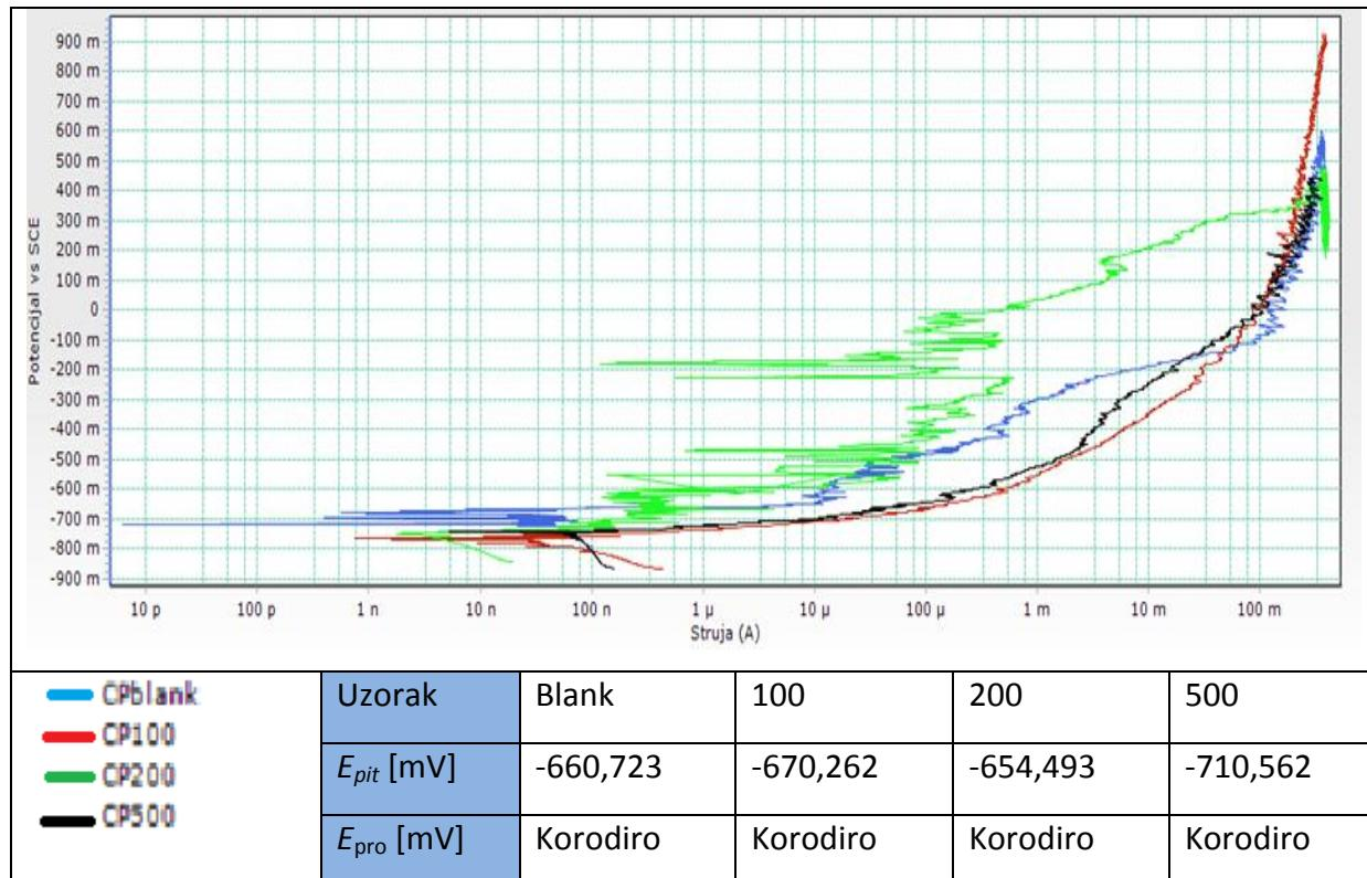
Dio uzoraka tokom provođenja cikličkog polarizacijskog ispitivanja je korodirao, što je bilo vidljivo i golim okom, dok uzorci koji nisu korodirali sačuvali su isti izgled površine koju su imali prije ispitivanja.
