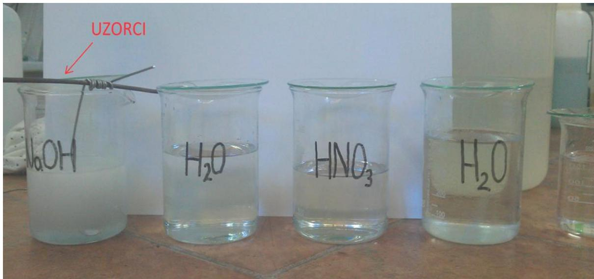
**Slika 25. Kemijska obrada površine uranjanjem**
