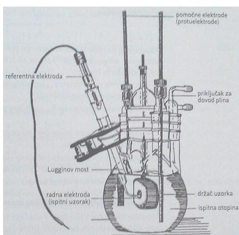
**Slika 21. Tipični raspored elektroda pri elektrokemijskim ispitivanjima [38]**
