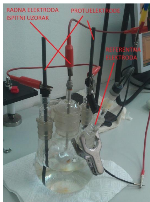
Slika 38. Raspored spajanja tokom elektrokemijskih ispitivanja
