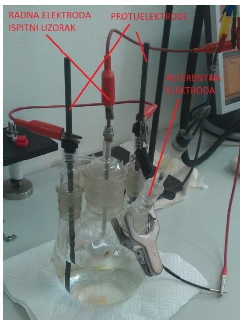
Slika 38. Raspored spajanja tokom elektrokemijskih ispitivanja
