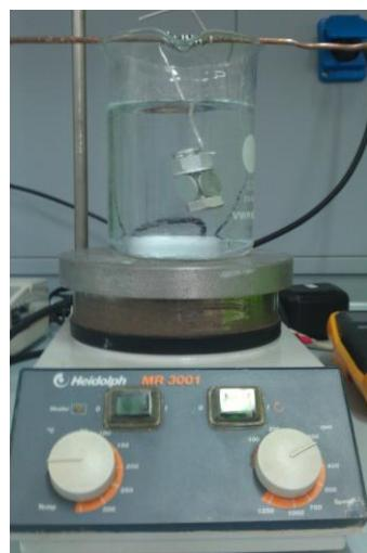
Slika 30. Ispiranje uzorka na elektromagnetskoj miješalici
