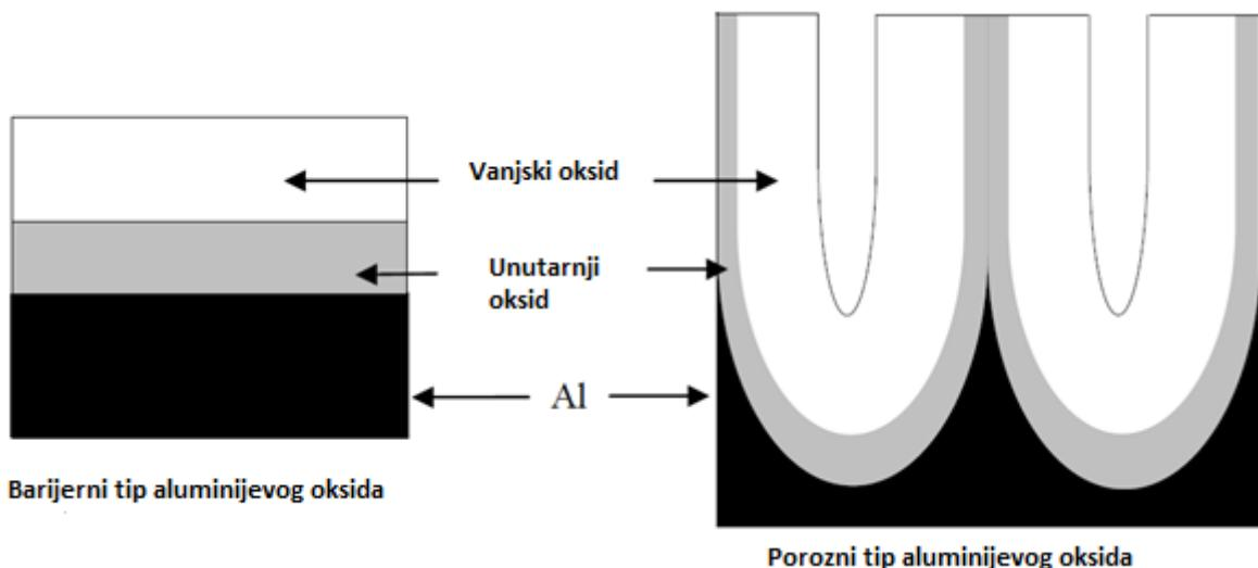
Slika 6. Barijerni i porozni tip aluminijevog oksida [24]
