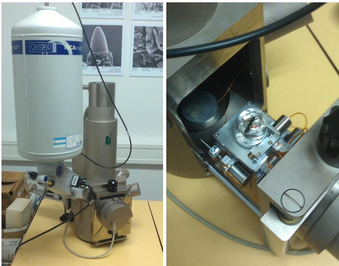
Slika 34. Uredaj za SEM i EDX analizu (lijevo) te ispitna vakuumska komora istog (desno)
