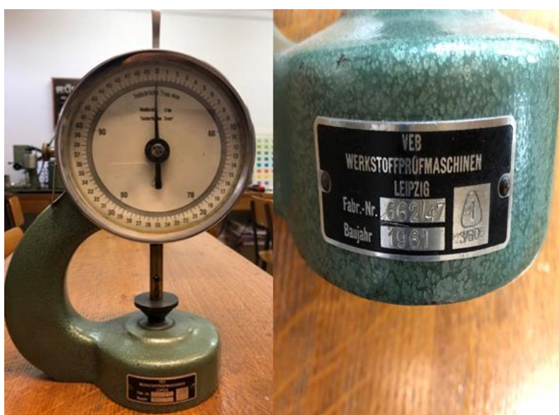
Slika 37. Uređaj za mjerenje debljine folija
