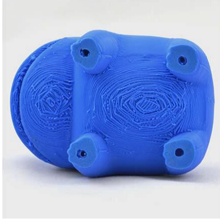
Slika 3.33. Loša površina proizvoda iznad podupora [12]
