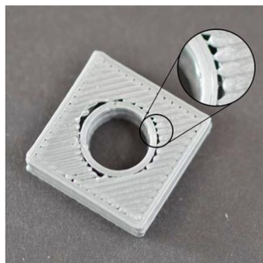
Slika 3.24. Praznine između ispune i konture [12]
