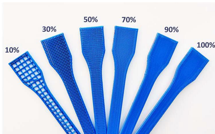
Slika 4.1. Prikaz postotka ispune na ispitnim epruvtama [12]
