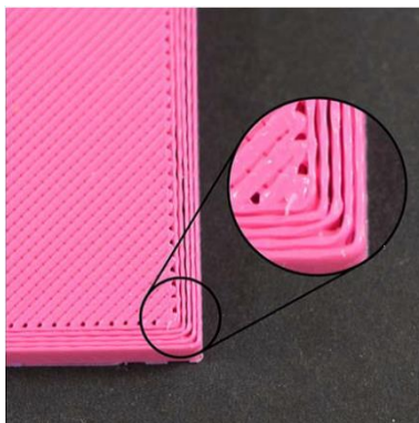
Slika 3.12. Nedovoljno ekstrudiranje materijala [12]
