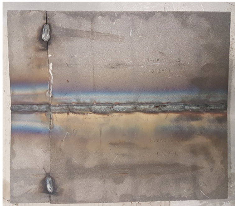
Slika 14. Zavarena ploča od čelika S355J0WP – korijen zavora
