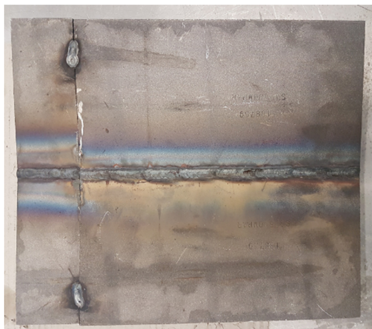
Slika 14. Zavarena ploča od čelika S355J0WP – korijen zavora
