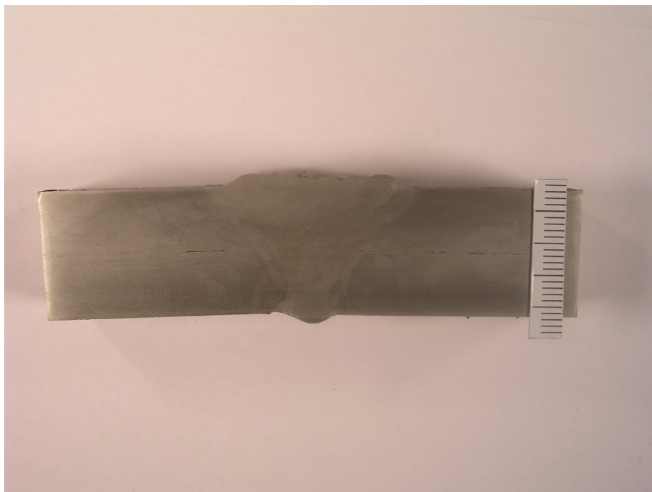
Slika 28. Uzorak nakon nagrižanja
