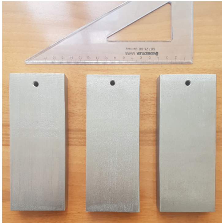
Slika 16. Uzorci sa zavarom – tjeme zavara
