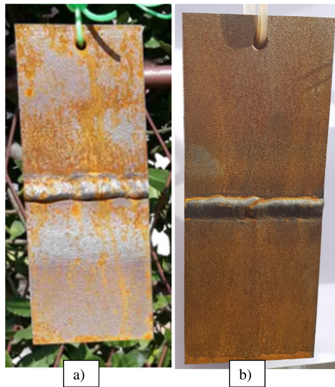
Slika 18. Uzorci sa zavarenim spojem nakon 15 dana izlaganja djelovanju morske (a) i industrijske (b) atmosfere
