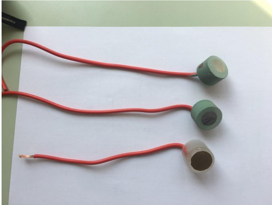
Slika 38. Uzorci pripremljeni za elektrokemijska ispitivanja [56]
