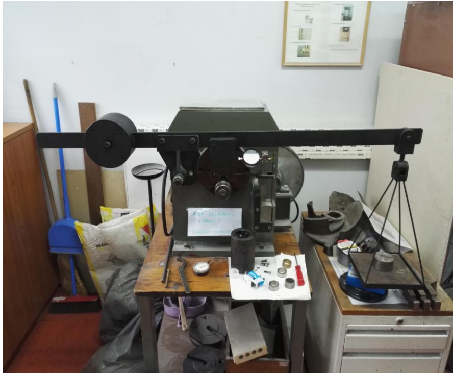
Slika 44. Uređaj za ispitivanje otpornosti na adhezijsko trošenje
