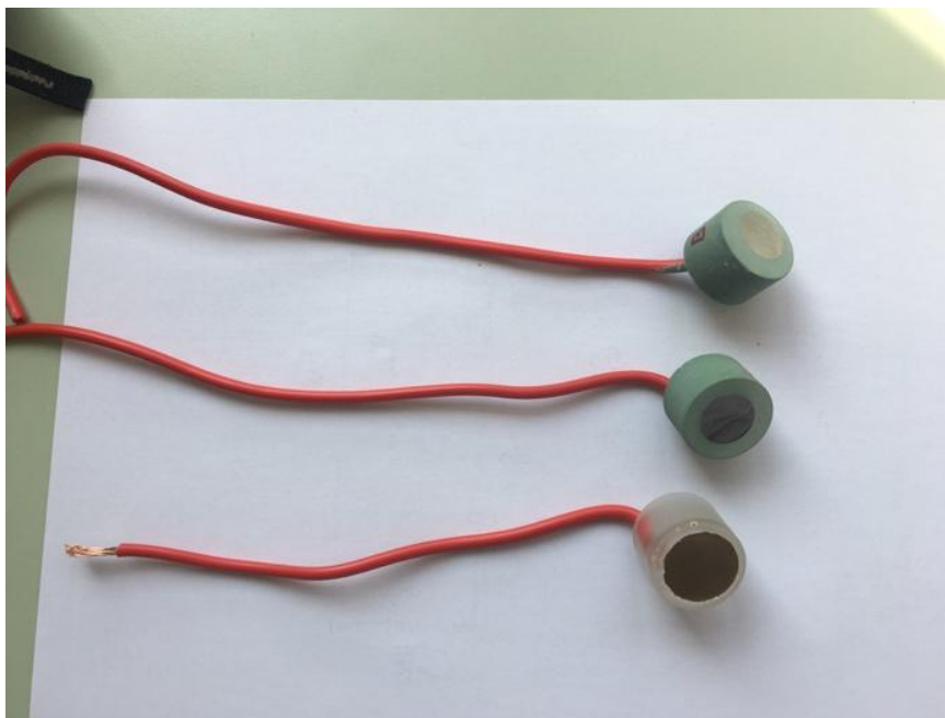
Slika 38. Uzorci pripremljeni za elektrokemijska ispitivanja [56]
