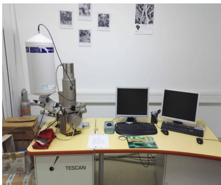
Slika 32. Skenirajući elektronski mikroskop (SEM) Tescan Vega TS5136LS [56]
