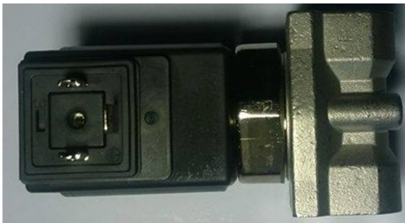
Slika 12. Elektromagnetski razvodnik oznake VX2350K
