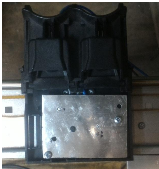
Slika 61. Konstrukcija kućišta električnog tipkala
