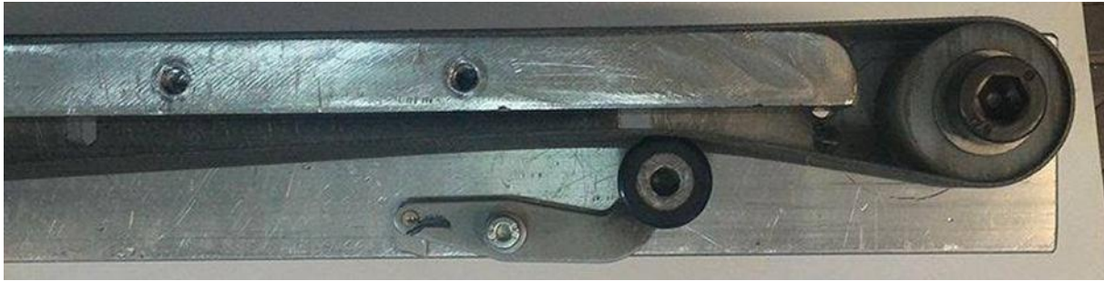
Slika 31. Priteznik na transportnoj traci
