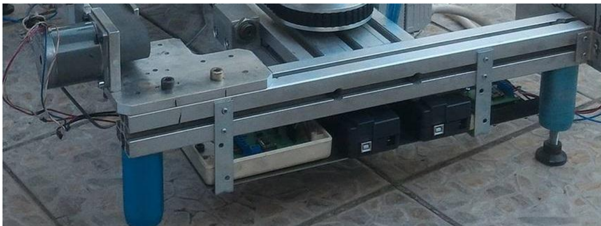
Slika 69. Kućište upravljačkog sustava na manipulatoru
