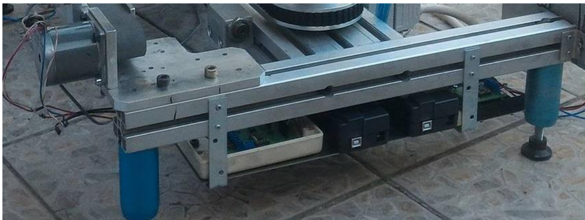
Slika 69. Kućište upravljačkog sustava na manipulatoru
