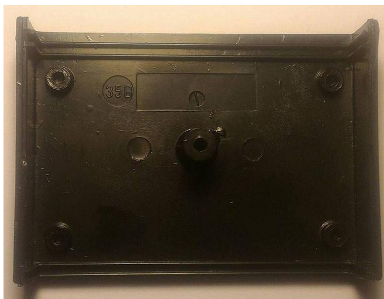
Slika 66. Kućište za upravljački sklop istosmjernog motora
