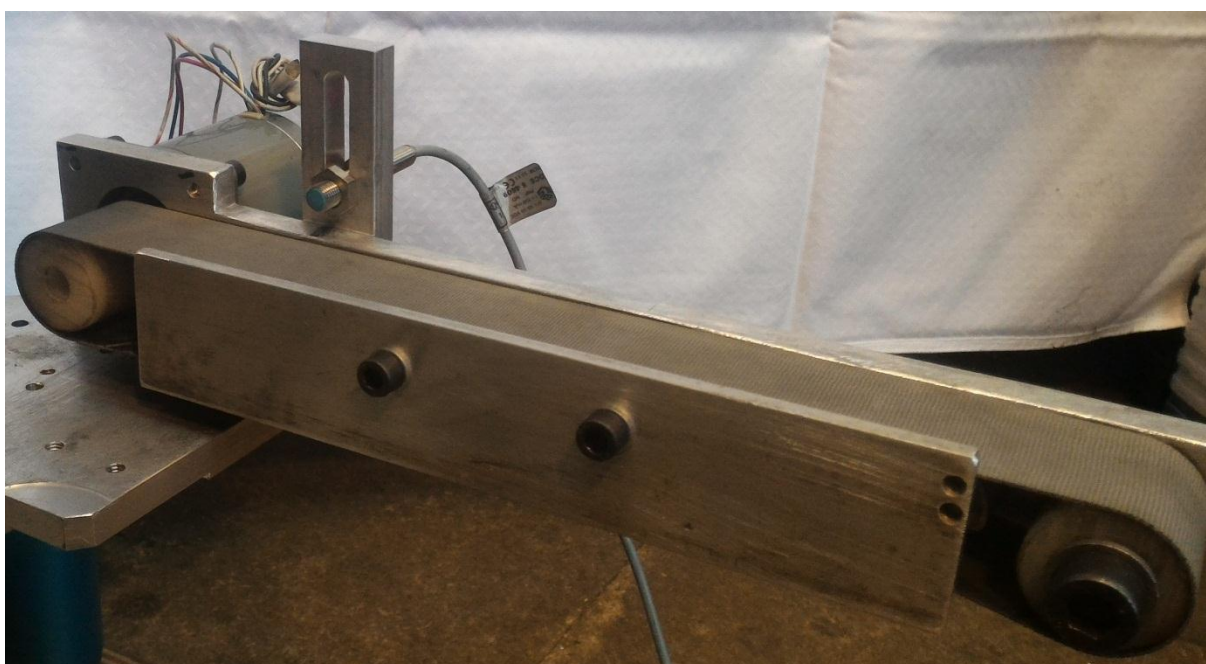
Slika 46. Ugradnja senzora na pokretnu traku
