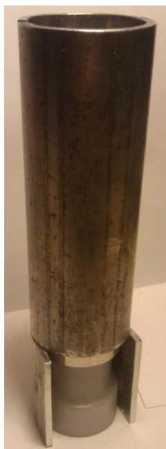
Slika 74. Spremište dostavne gravitacijske staze
