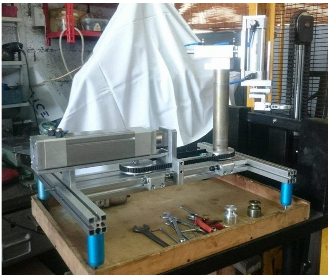
Slika 5. Konstrukcija pneumatskog manipulatora [6]
