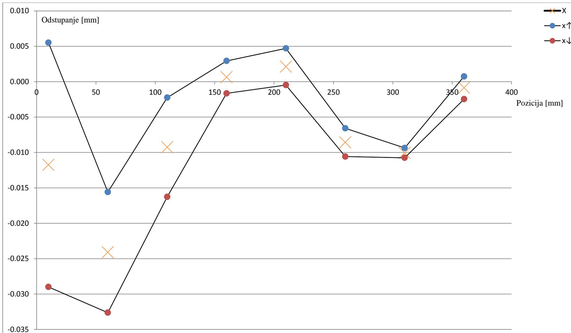
Slika 27 Dvosmjerna greška pozicioniranja osi X
