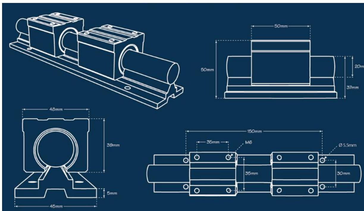
Slika 6 Dimenzije SBR20 sustava ležajeva [9]
