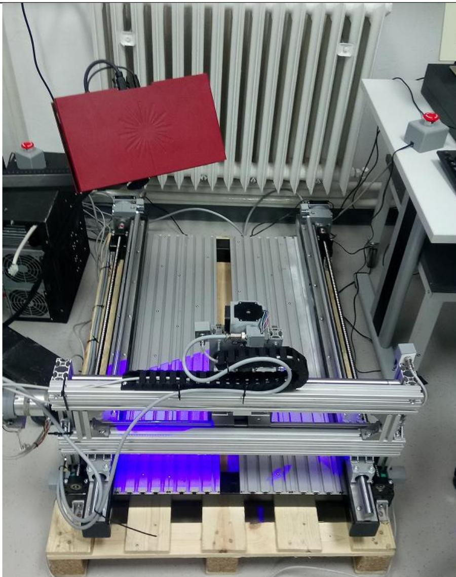
**Slika 21** Praćenje pomaka pomoću skenera ATOS Core 500
