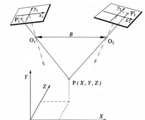
**Slika 10** Triangulacija položaja točke P primjenom dvije kamere [13]
