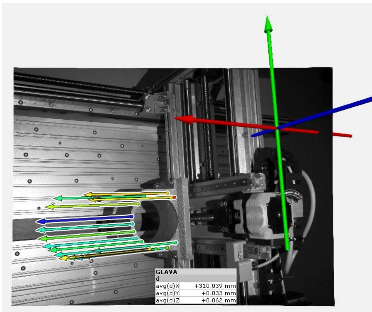
Slika 29 Primjer pomaka po osima  $X$ ,  $Y$  i  $Z$  prilikom pomicanja stroja
