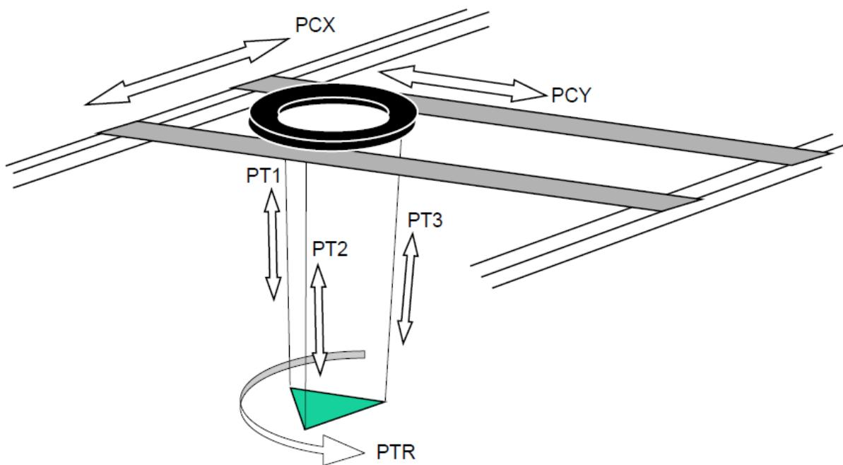
Slika 2.1: Opći kinematički koncept PFCT-a, [5]
