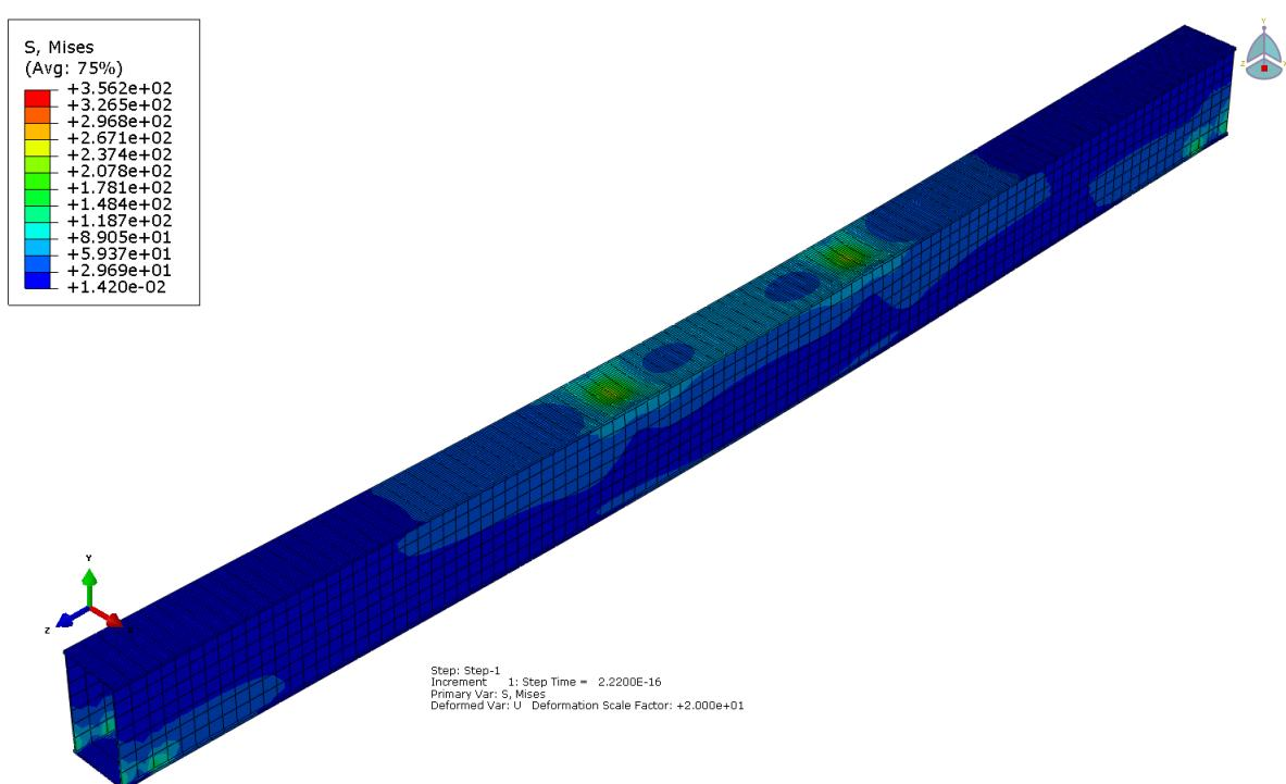
Slika 3.20: Prikaz naprezanja u N/mm<sup>2</sup> dobivenih korištenjem 3D elementa
