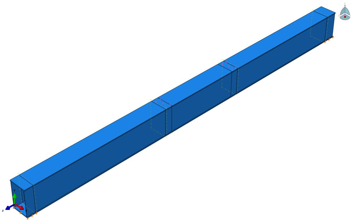
Slika 3.13: Modeliranje opterećenja 3D prizmatičnim elementima u Abaqusu
