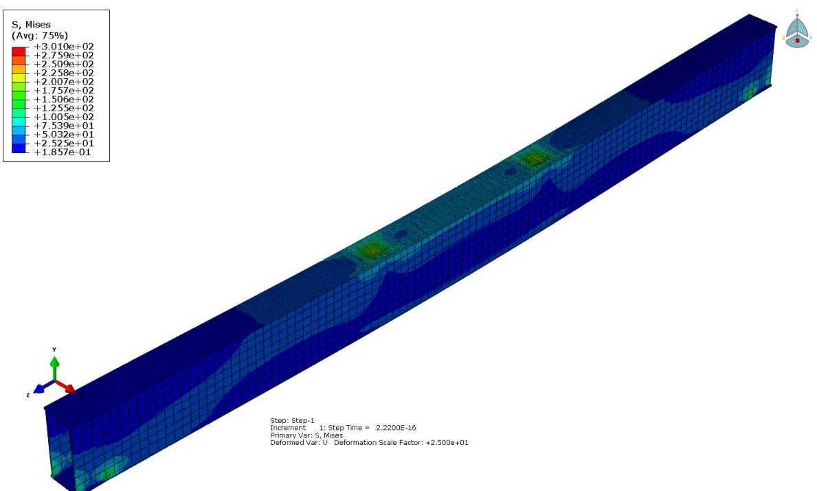
Slika 3.25: Prikaz naprezanja u N/mm<sup>2</sup> dobivenih korištenjem 3D elementa
