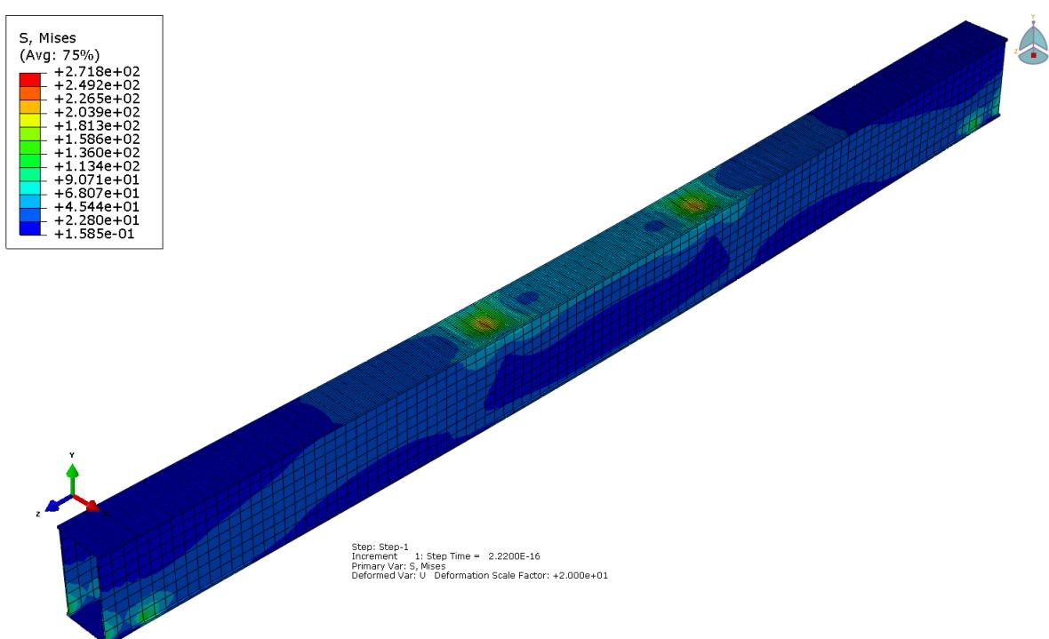
Slika 3.29: Prikaz naprezanja u N/mm<sup>2</sup> dobivenih korištenjem 3D elementa
