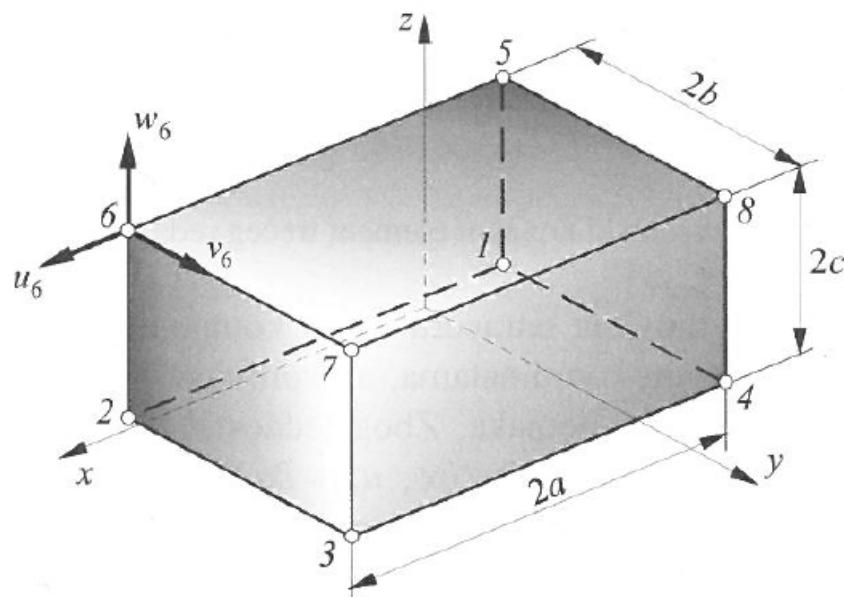
Slika 3.8: Osnovni prizmatični element s 24 stupnja slobode, [7]
