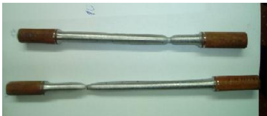
Slika 12 Epruvete nakon ispitivanja pri brzini prirasta opterećenja 10 \text{ N/mm}^2 \cdot \text{s}^{-1}
