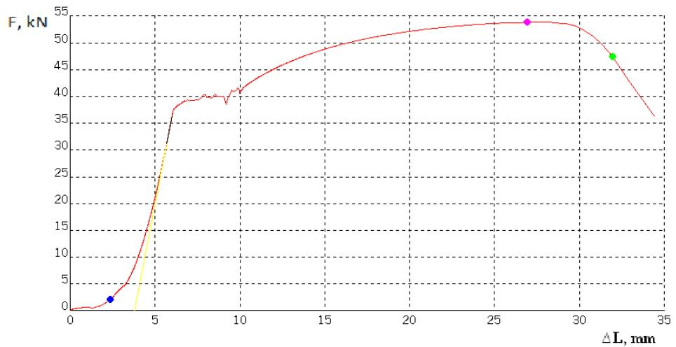
Slika 18 Dijagram sila – produljenje za epruvetu A2
