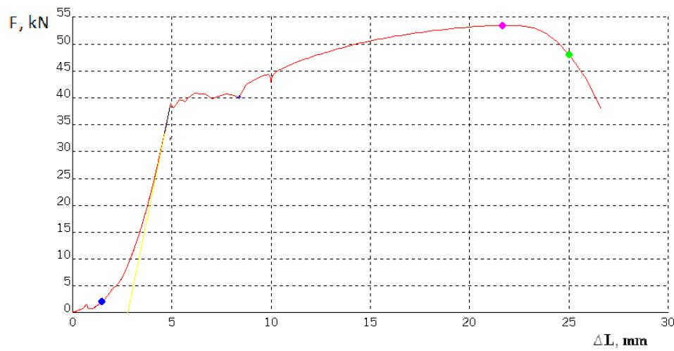
Slika 25 Dijagram sila – produljenje za epruvetu C3
