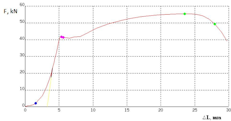
Slika 37 Dijagram sila – produljenje za epruvetu G3
