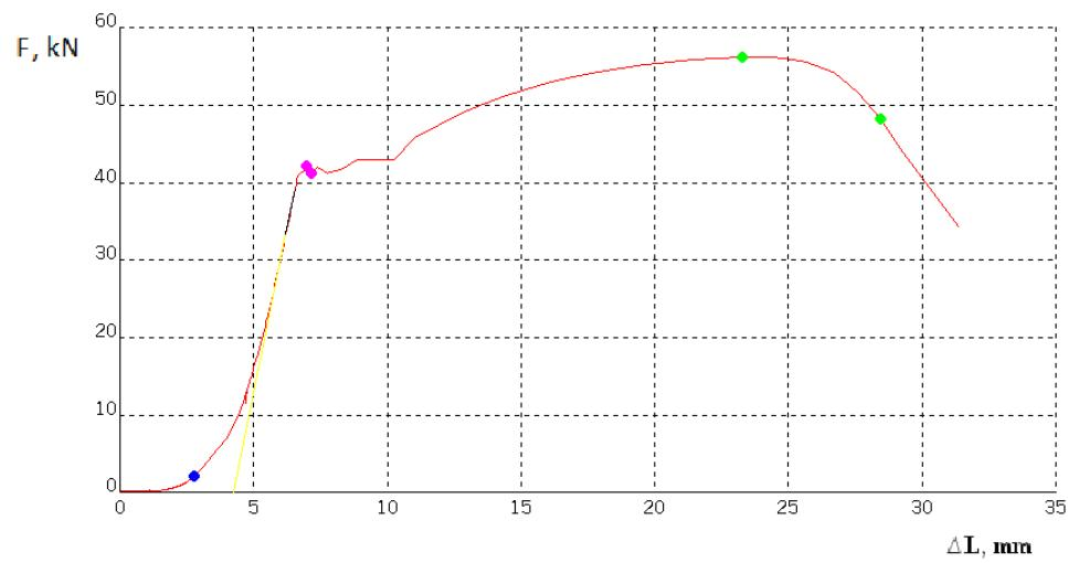
Slika 33 Dijagram sila – produljenje za epruvetu F2
