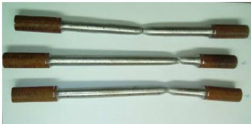
Slika 14 Epruvete nakon ispitivanja pri brzini prirasta opterećenja 30 \text{ N/mm}^2 \cdot \text{s}^{-1}
