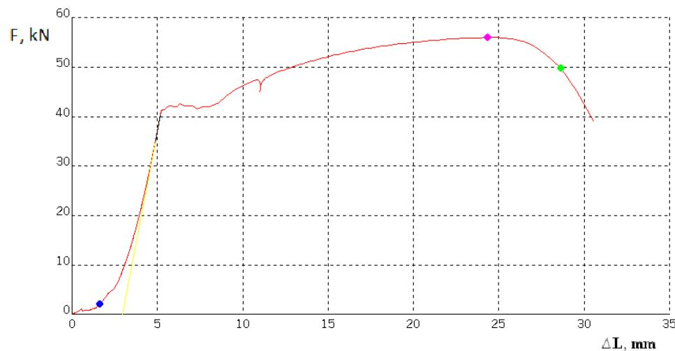
Slika 23 Dijagram sila – produljenje za epruvetu C1
