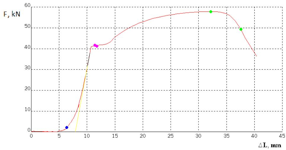
Slika 34 Dijagram sila – produljenje za epruvetu F3
