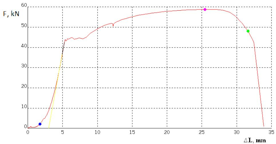
Slika 27 Dijagram sila – produljenje za epruvetu D2
