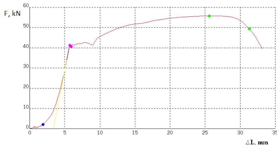
Slika 29 Dijagram sila – produljenje za epruvetu E1
