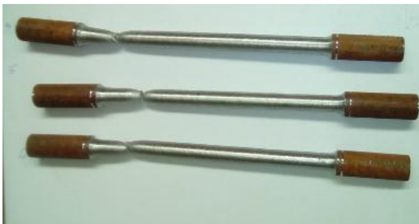
Slika 15 Epruvete nakon ispitivanja pri brzini prirasta opterećenja 50 \text{ N/mm}^2 \cdot \text{s}^{-1}
