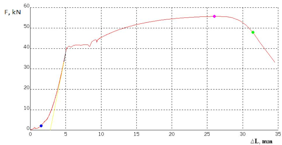
Slika 22 Dijagram sila – produljenje za epruvetu B3
