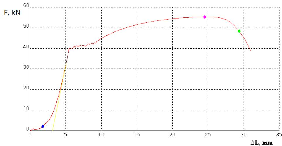
Slika 21 Dijagram sila – produljenje za epruvetu B2
