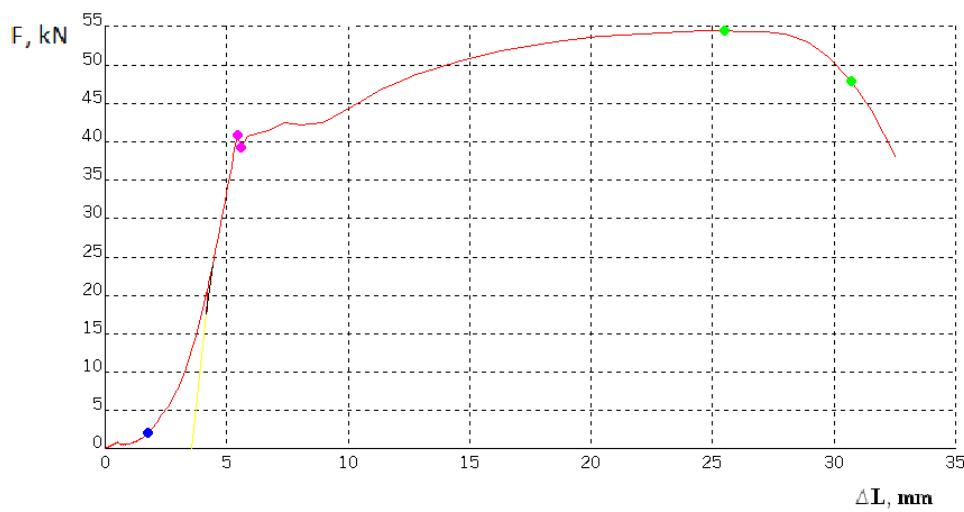
Slika 36 Dijagram sila – produljenje za epruvetu G2
