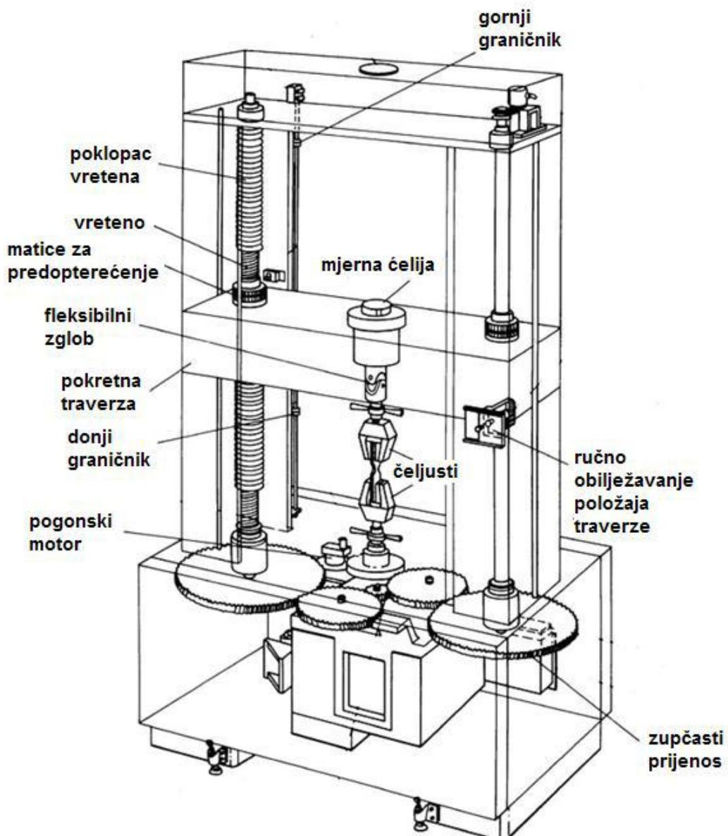
Slika 7 Elektromehanička kidalica
