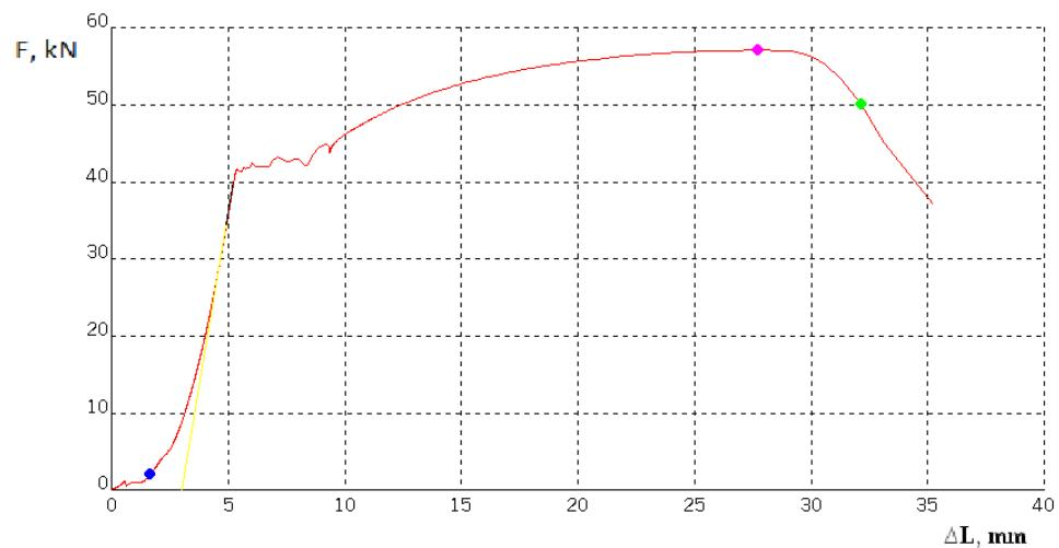
Slika 20 Dijagram sila – produljenje za epruvetu B1
