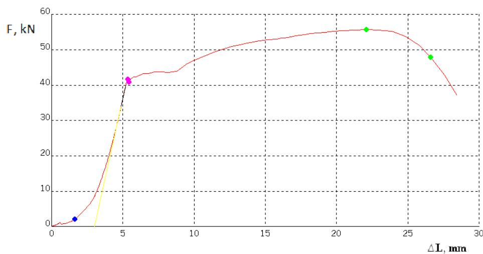
Slika 30 Dijagram sila – produljenje za epruvetu E2
