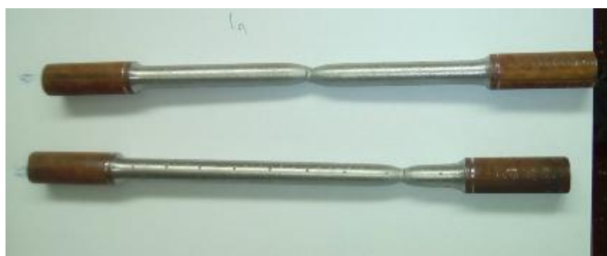
Slika 11 Epruvete nakon ispitivanja pri brzini prirasta opterećenja 5 \text{ N/mm}^2 \cdot \text{s}^{-1}
