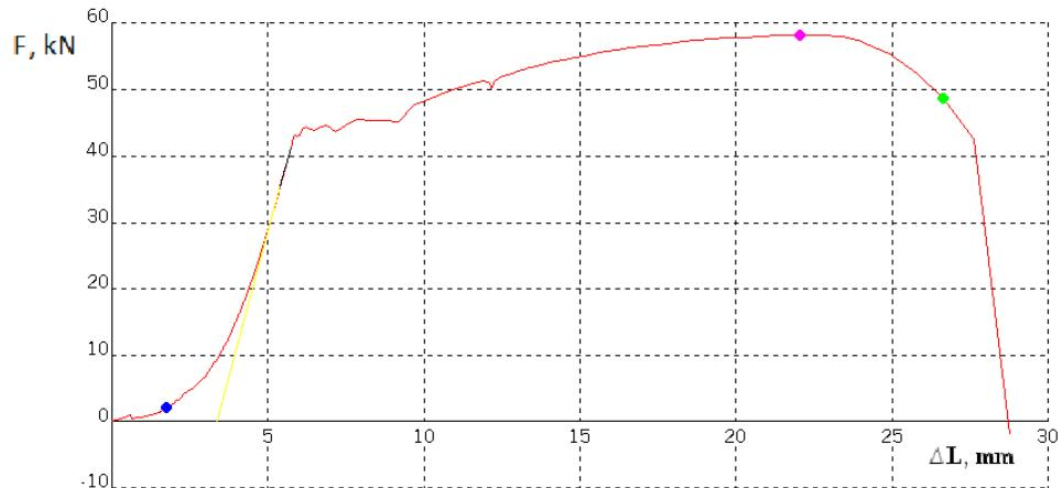
Slika 26 Dijagram sila – produljenje za epruvetu D1
