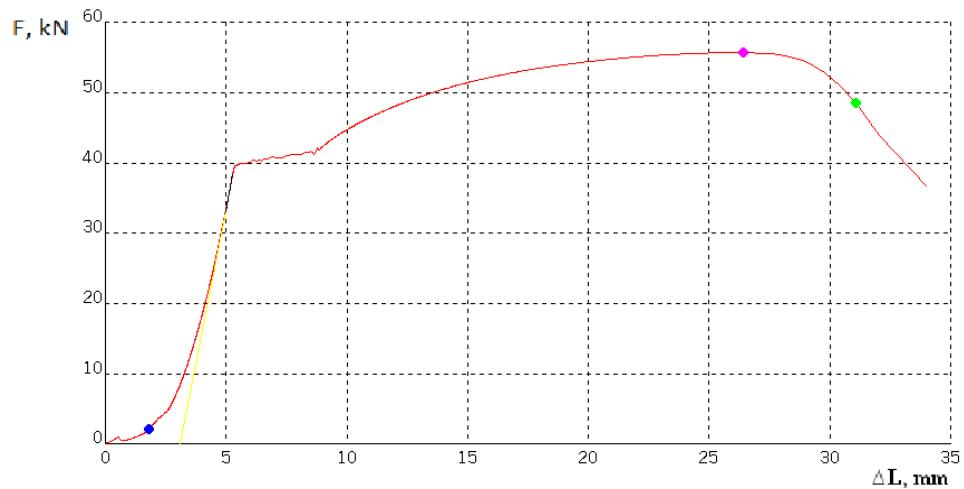
Slika 17 Dijagram sila – produljenje za epruvetu A1
