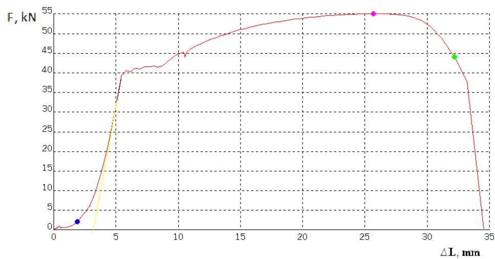
Slika 24 Dijagram sila – produljenje za epruvetu C2
