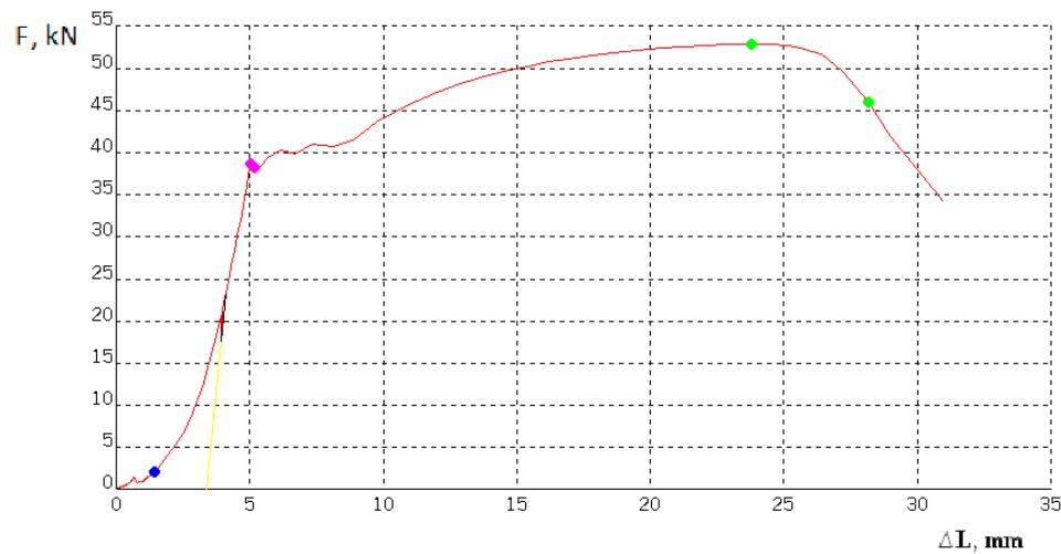
Slika 35 Dijagram sila – produljenje za epruvetu G1
