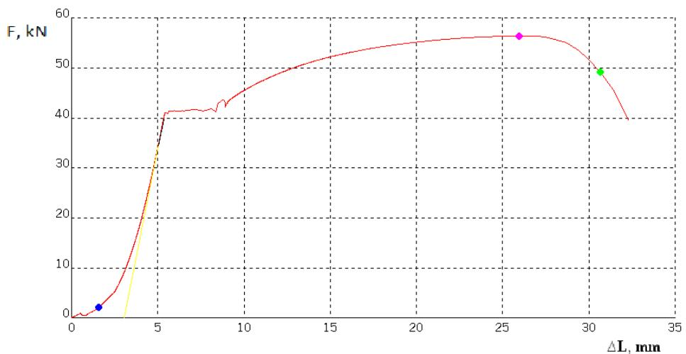
Slika 19 Dijagram sila – produljenje za epruvetu A3
