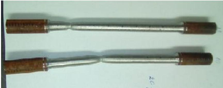
Slika 13 Epruvete nakon ispitivanja pri brzini prirasta opterećenja 20 \text{ N/mm}^2 \cdot \text{s}^{-1}
