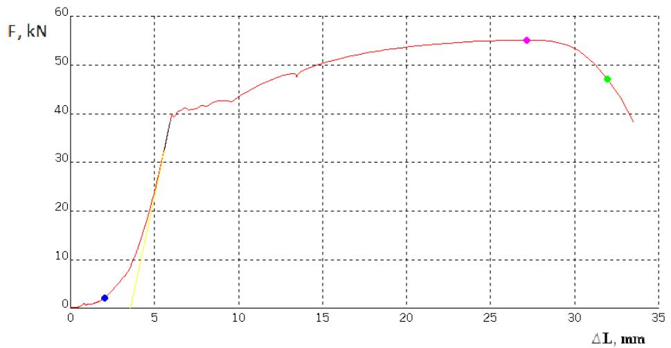
Slika 28 Dijagram sila – produljenje za epruvetu D3
