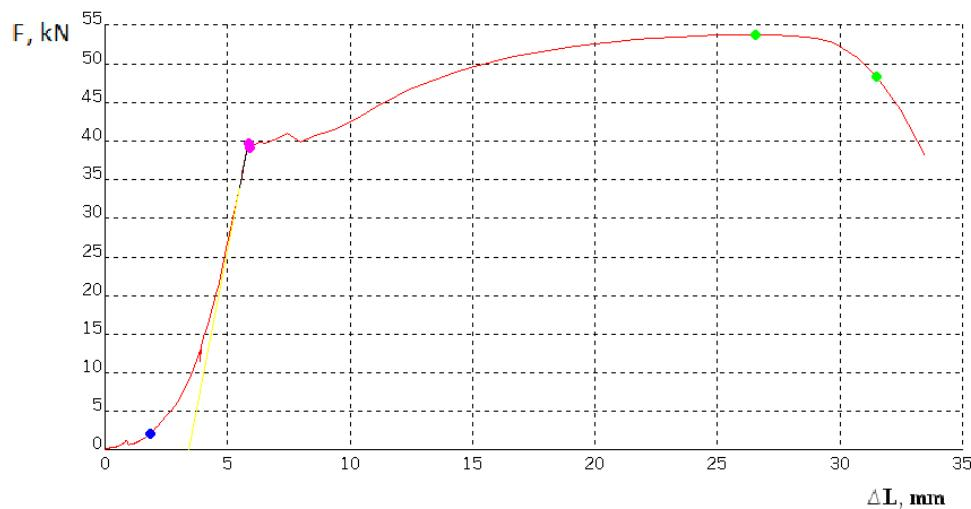
Slika 32 Dijagram sila – produljenje za epruvetu F1
