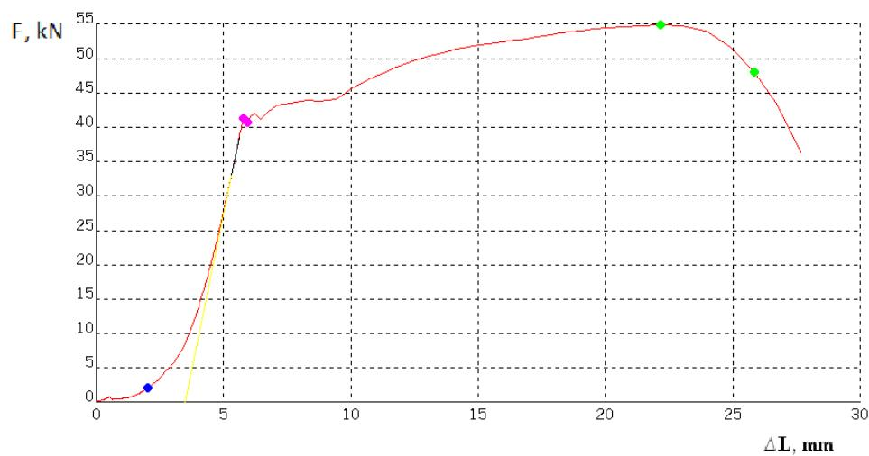
Slika 31 Dijagram sila – produljenje za epruvetu E3
