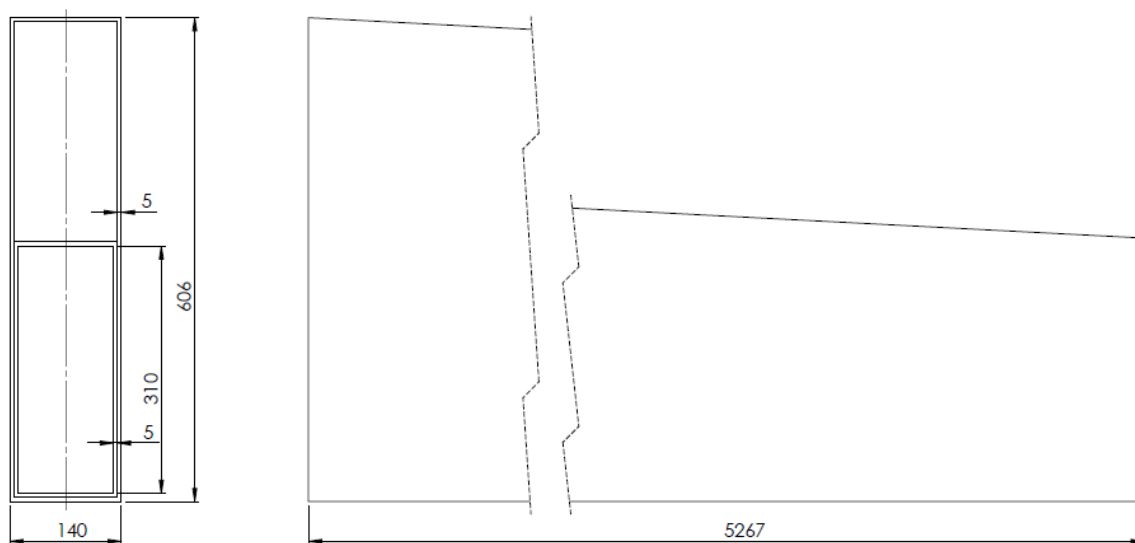
Slika 12. Prikaz dimenzija velikog kutijastog nosača
