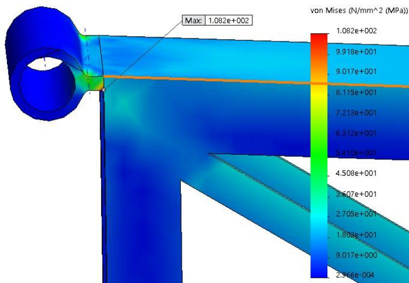
Slika 95. Prikaz najveće koncentracije naprezanja prema Von Misesu
