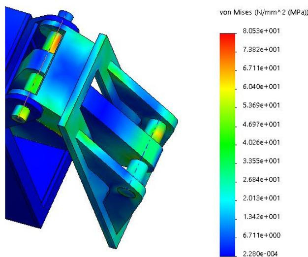
Slika 60. Prikaz raspodjele naprezanja prema Von Misesu
