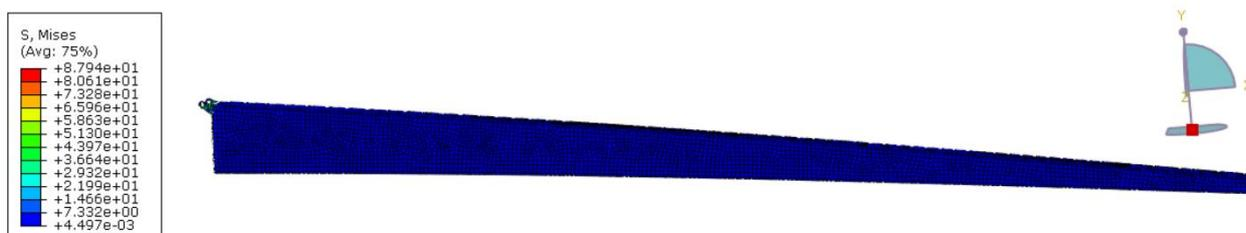
Slika 67. Rezultati naprezanja malog kutijastog nosača prema Von Misesu
