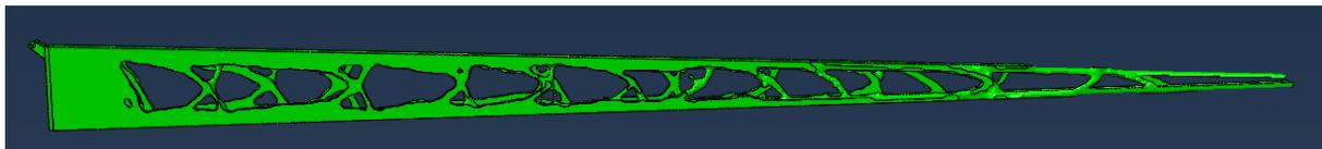
**Slika 73. Izgled optimiranog malog kutijastog nosača sa maksimalno 16% volumena**
