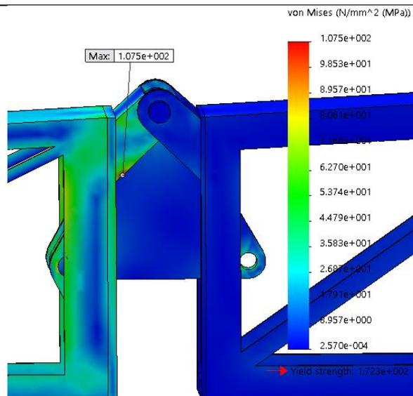
Slika 92. Prikaz najveće koncentracije naprezanja prema Von Misesu
