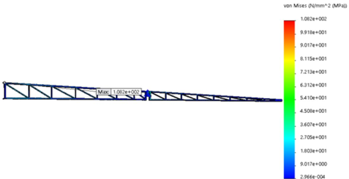
Slika 94. Raspodjela naprezanja prema Von Misesu
