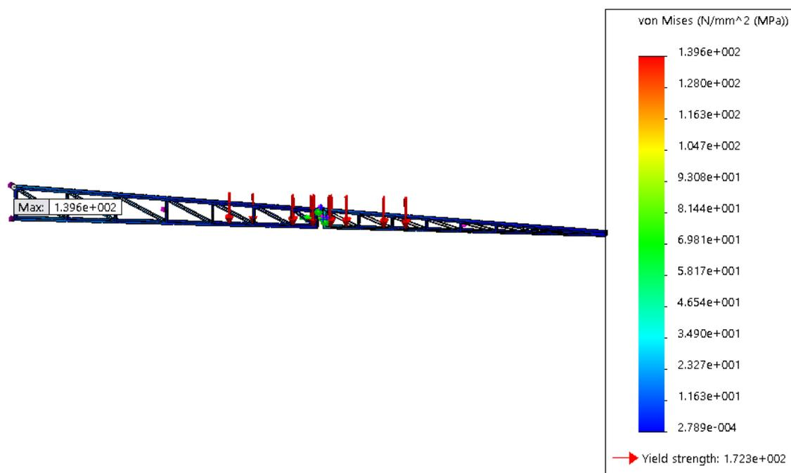
**Slika 86. Raspodjela napreznaja prema Von Misesu rešetkastog nosača**
