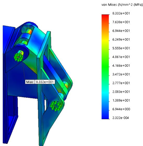
Slika 63. Prikaz koncentracije naprezanja prema Von Misesu
