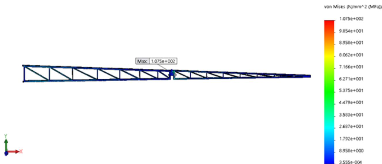
Slika 97. Prikaz raspodjele naprezanja prema Von Misesu
