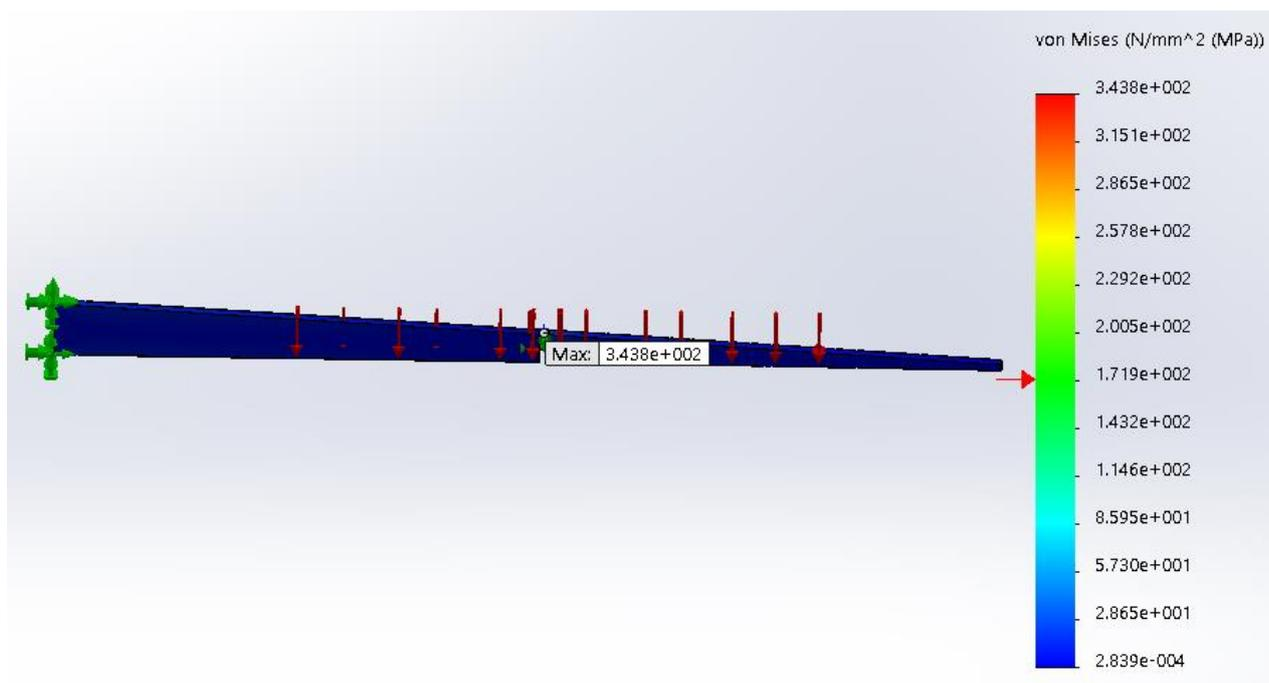
Slika 26. Raspodjela napreznja rampe posipača prema Von Misesu
