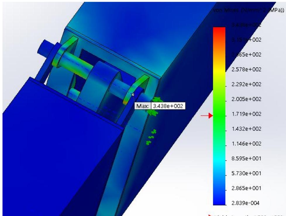
Slika 27. Raspodjela naprezanja prema Von Misesu na kritičnim mjestima
