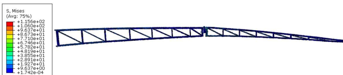
**Slika 111. Rezultati naprezanja rampe posipača prema Von Misesu uslijed opterećenja težina velikog i malog rešetkastog nosača, velikog i malog kotača i hidrauličkog cilindra**
