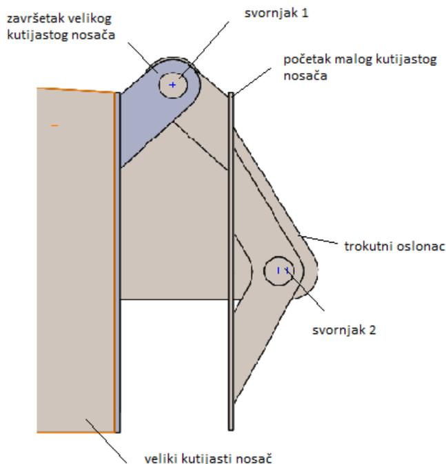
**Slika 10. Prikaz pojedinih dijelova u sklopu rampe posipača**
