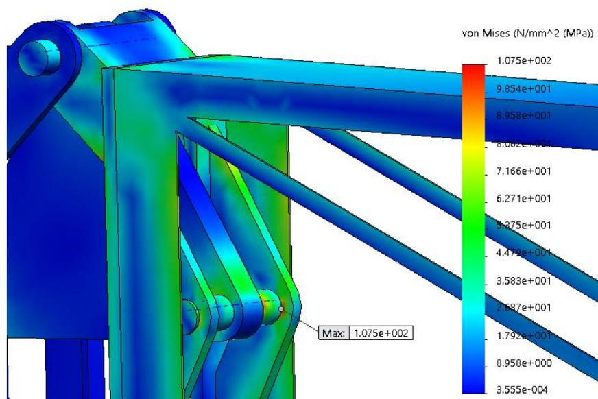
Slika 98. Prikaz najveće koncentracije naprezanja prema Von Misesu
