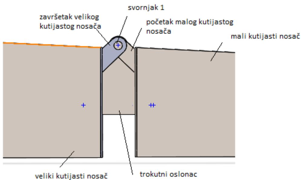
Slika 9. Prikaz pojedinih dijelova u sklopu rampe posipača
