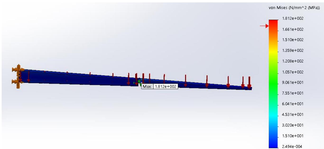
Slika 31. Raspodjela napreznja rampe posipača prema Von Misesu
