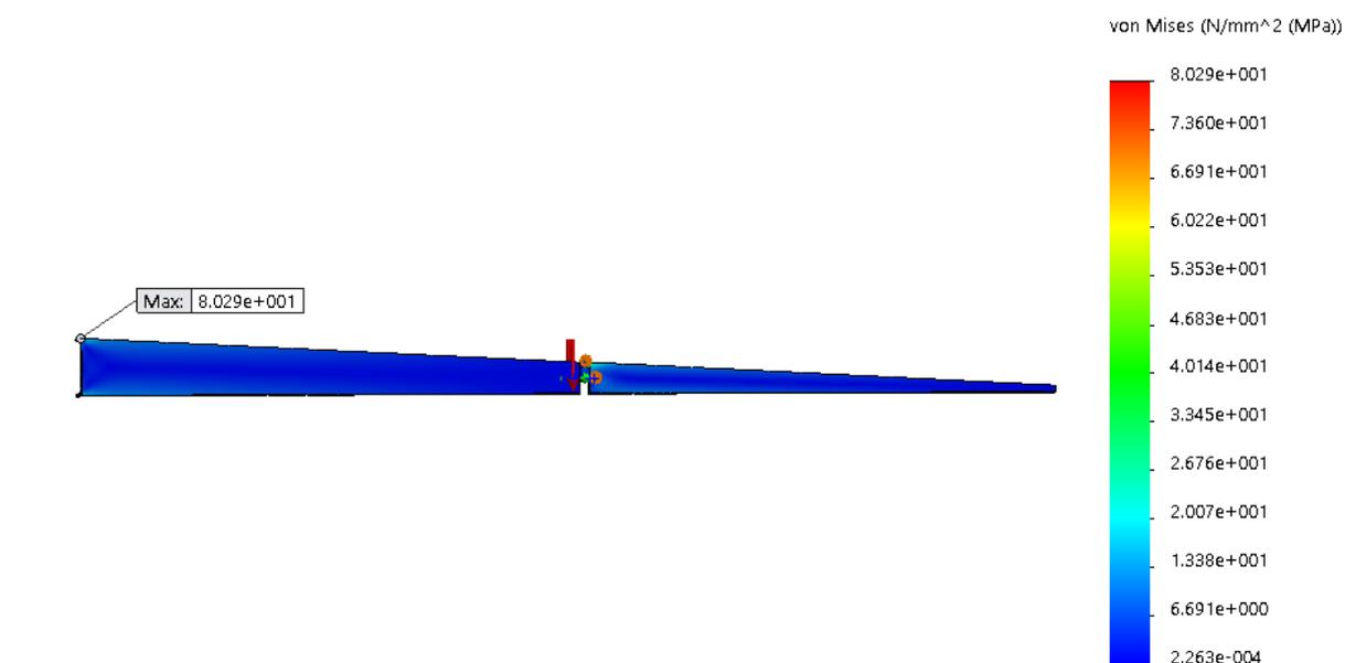
Slika 53. Raspodjela naprezanja prema Von Misesu
