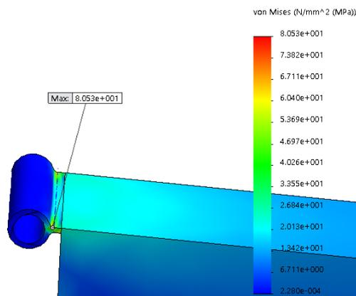
Slika 59. Prikaz najveće koncentracije naprezanja prema Von Misesu
