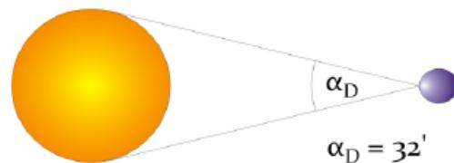
*Slika 6 Varijacija u ulaznom kutu direktognog solarnog zračenja [1]*
