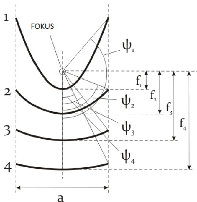
Slika 4 Oblici parabole [1]
