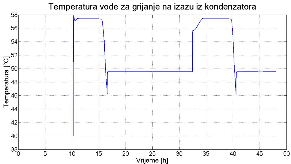
*Slika 26 Temperatura vode za grijanje na izazu iz kondenzatora*
