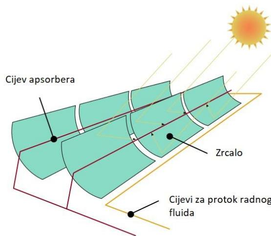
*Slika 2 Parabolični protočni kolektori [1]*
