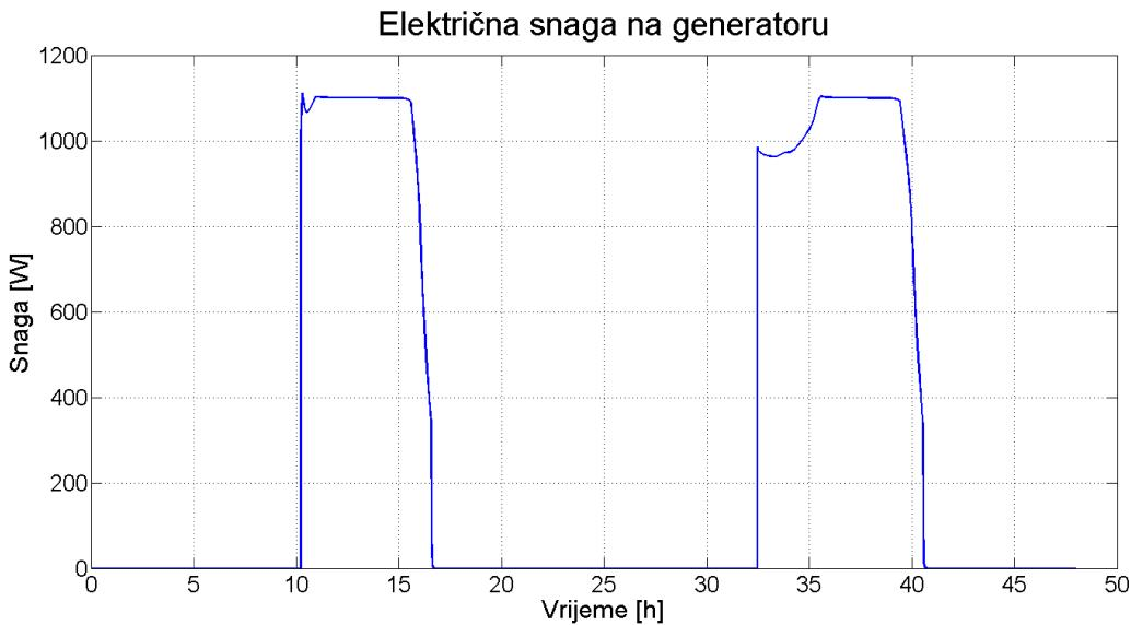
*Slika 28 Proizvodnja električne energije uz jutarnju naoblaku*
