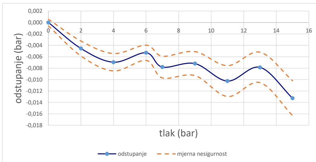
Slika 17. Grafčki prikaz odstupanja LAB REF (mjerenje 2)
