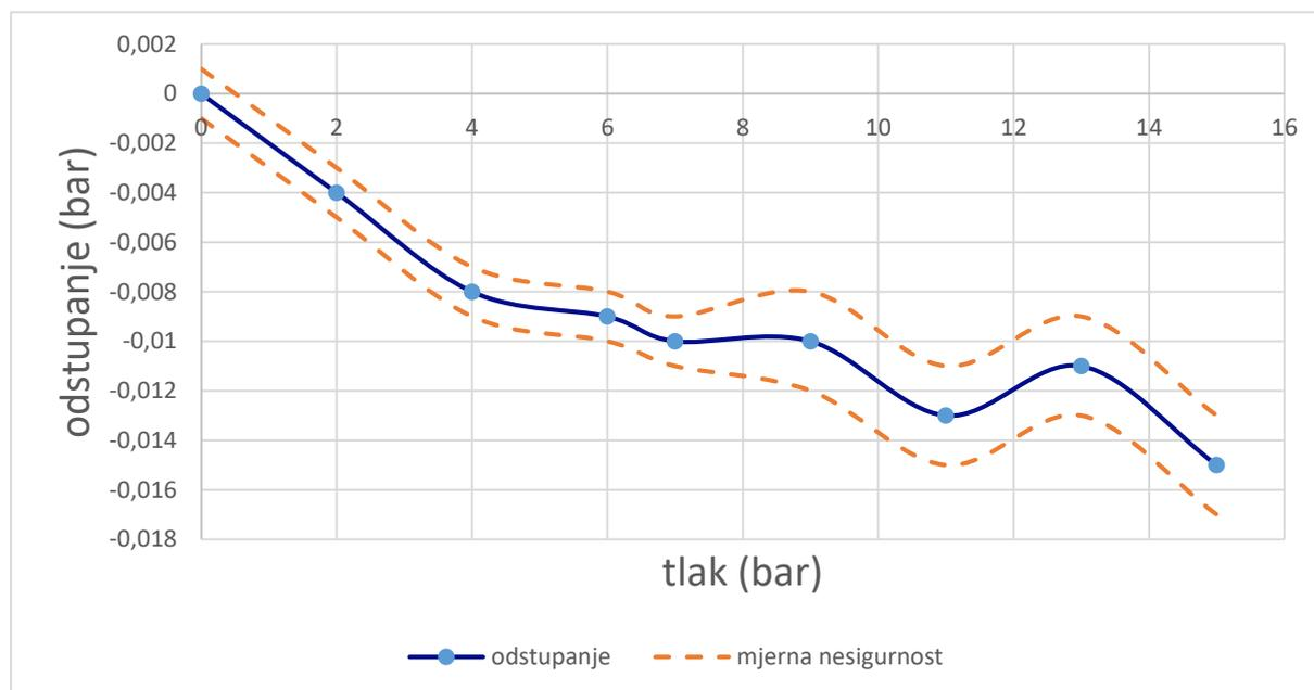
Slika 9. Grafički prikaz odstupanja LAB REF (mjerenje 1)
