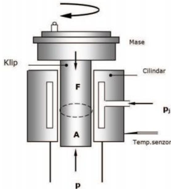
Slika 4. Presjek sklopa klip/cilindar sa pripadajućim fizikalnim veličinama
