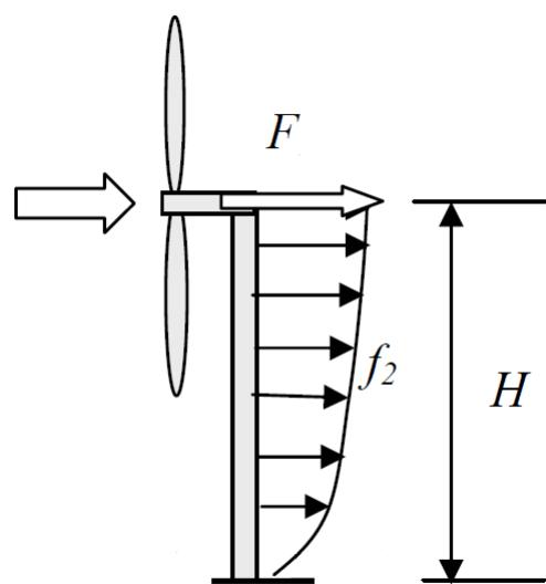
Slika 3.6: Uzbuđene sile na stup [17]
