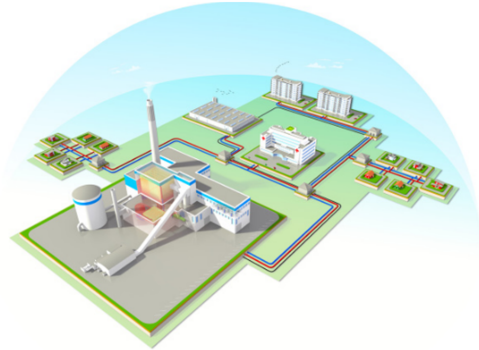
Slika 2. Ilustracija daljinskog sustava grijanja
