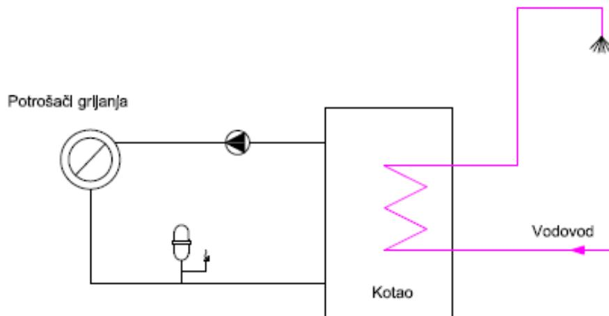
Slika 19. Jednostavna shema protočnog sustava zagrijavanja PTV-a
