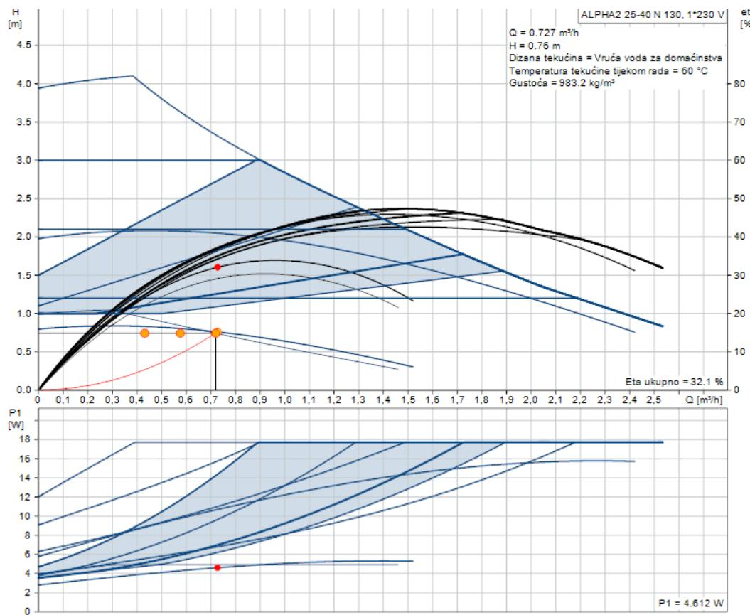
Slika 24. Prikaz radne točke pumpe "Grundfos ALPHA2 25-40 N130"
