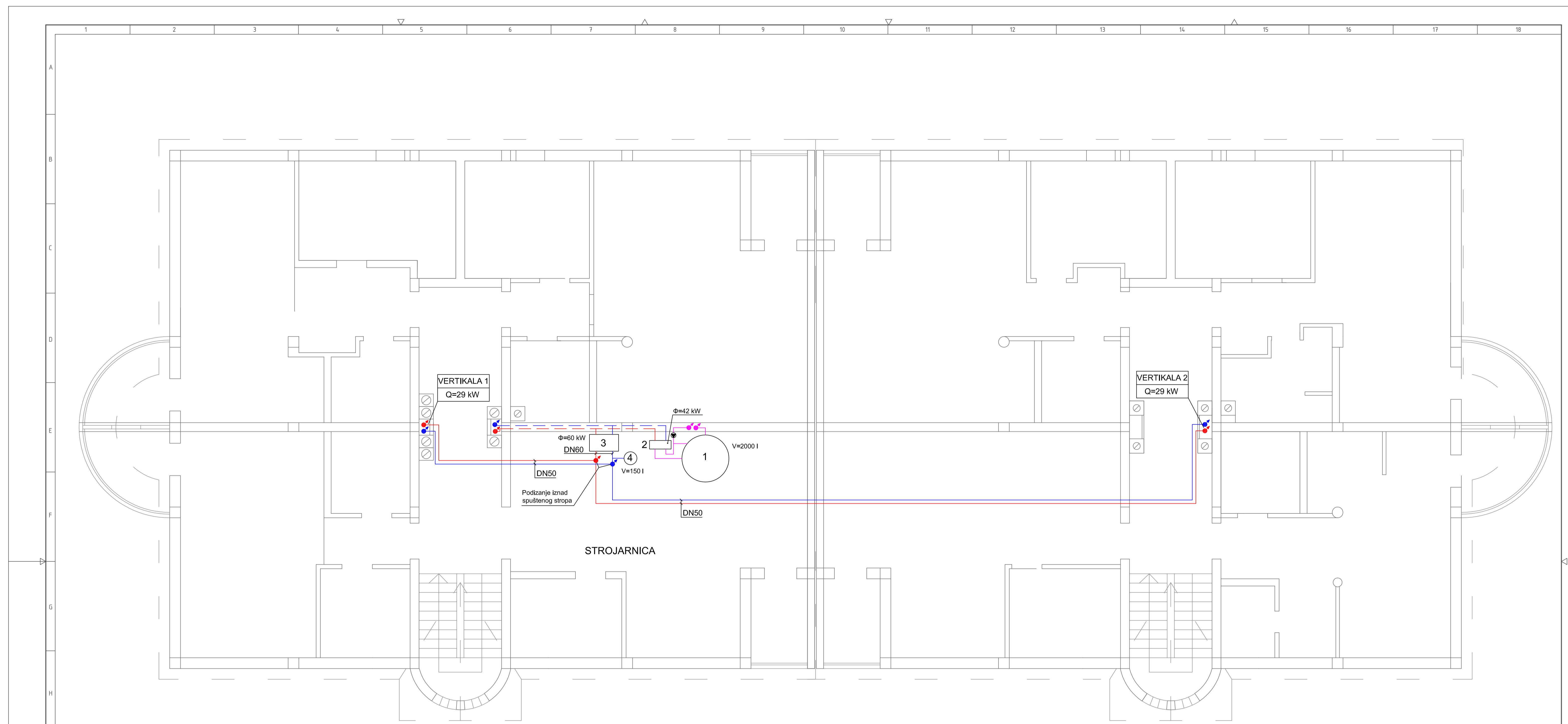
1 - akumulacijski spremnik za PTV (CENTROMETAL Cas 2001), zapremnina 2000 l, max. temperatura 60 °C
