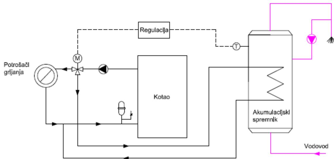
Slika 20. Jednostavna shema akumulacijskog sustava zagrijavanja PTV-a
