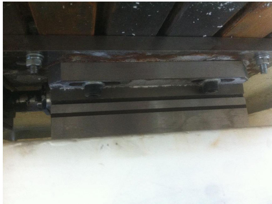
Slika 33. Postavljeni senzor sila
