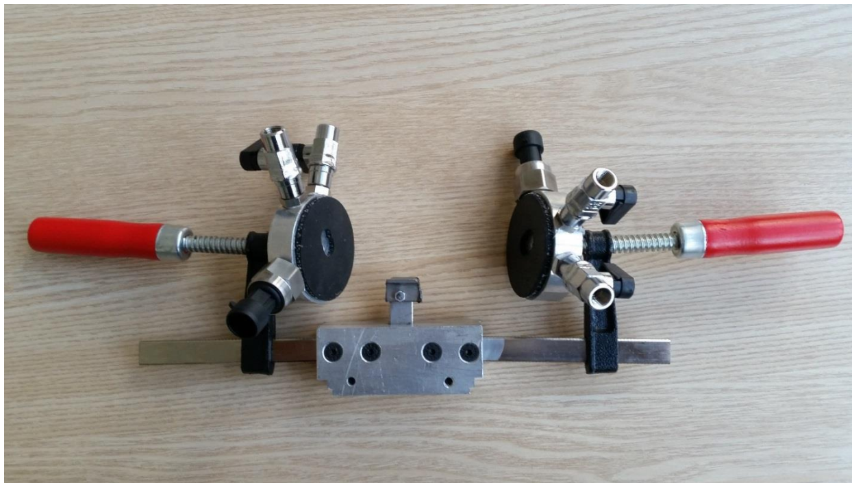
Slika 27. Naprava za prihvat koštanog uzorka
