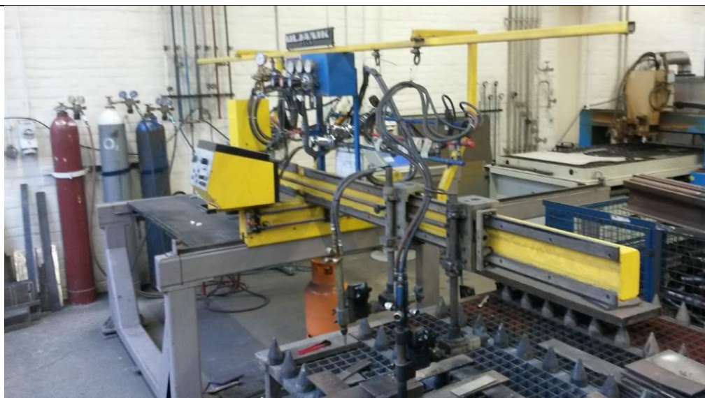
Slika 41. Sustav za plinsko rezanje Uljanik OPTOTAJ 15/20
