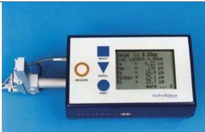
Slika 53. Uređaj za mjerenje hrapavosti SURTRONIC 25
