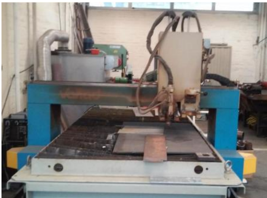
Slika 40. Prikaz sustava za plazma rezanje
