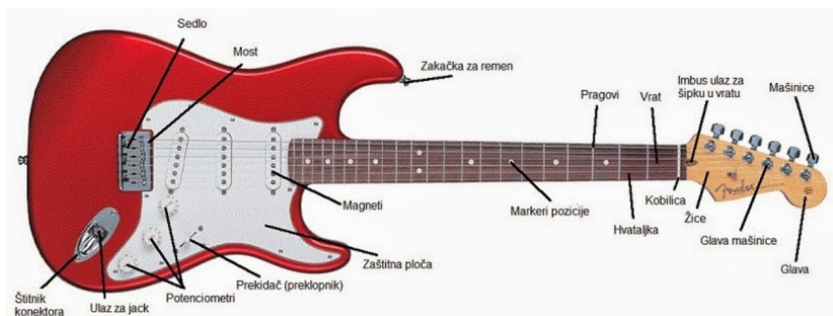
Slika 8. Dijelovi električne gitare [9]
