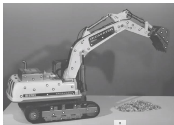
Slika 8. Pripremljeni mjerni objekt s referentnim markerima [6]
