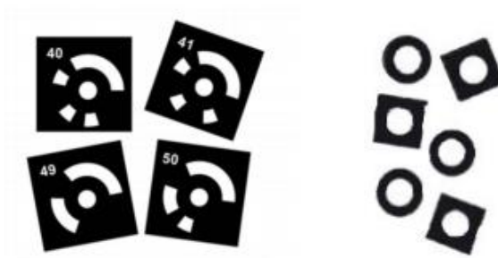
Slika 7. Mjerne točke (markeri), kodirane i nekodirane [7]
