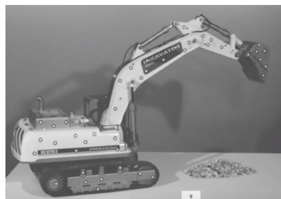
Slika 8. Pripremljeni mjerni objekt s referentnim markerima [6]
