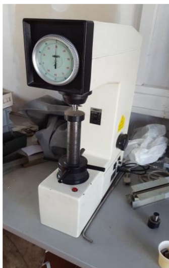
Slika 17. Rockwell-ov tvrdomjer INSIZE
