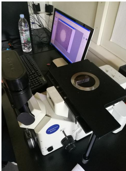
Slika 14. Ispitivanje traga trošenja na svjetlosnom mikroskopu
