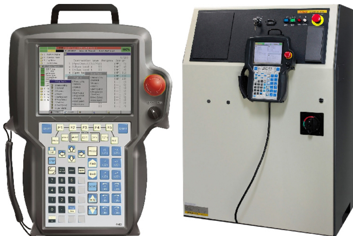
Slika 18. Upravljačka jedinica i privjesak za učenje [28]
