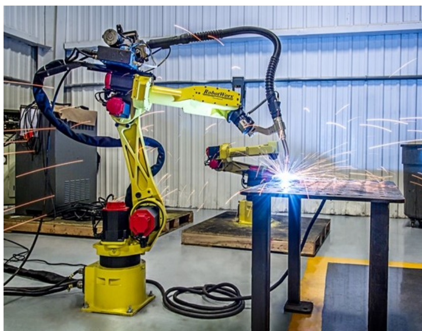
Slika 14. Robot za elektrolučno zavarivanje [21]
