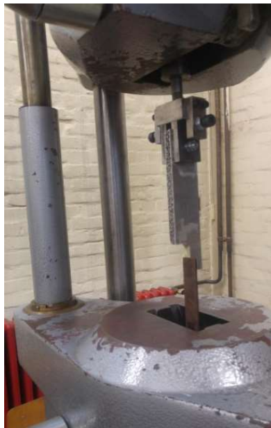
Slika 32. Uzorci postavljene na kidalici
