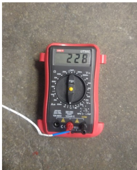
Slika 29. Temperatura u peći izmjerena digitalnim multimetrom UNI-T UT30C
