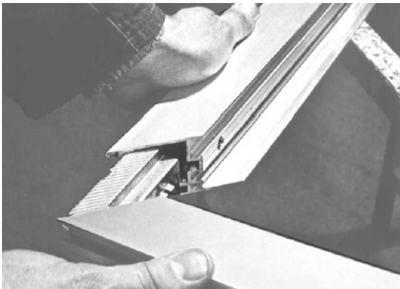
Slika 19. Spajanje aluminijskih okvira tehnologijom lijepljenja [24]
