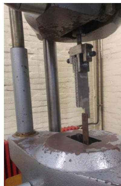
Slika 32. Uzorci postavljeni na kidalici
