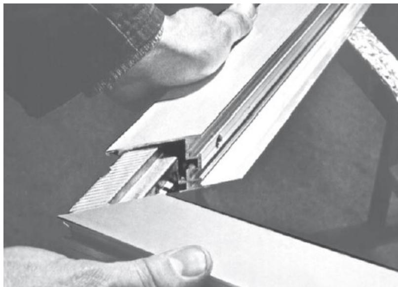
Slika 19. Spajanje aluminijskih okvira tehnologijom lijepljenja [24]
