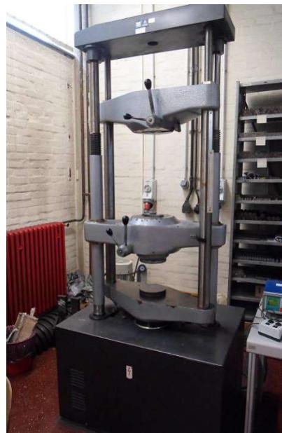
Slika 31. Univerzalna kidalica VEB Werkstoffprüfmaschinen GmbH
