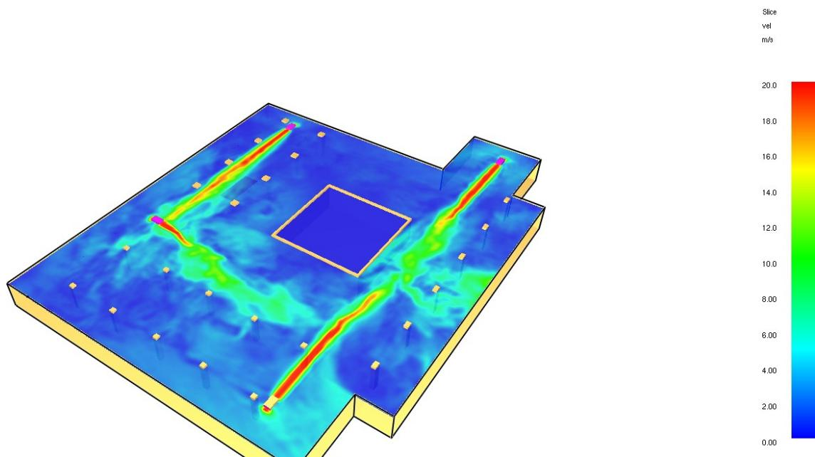
Slika 31. Konture polja brzine na visini od 3.1425 m nakon 45 minuta
