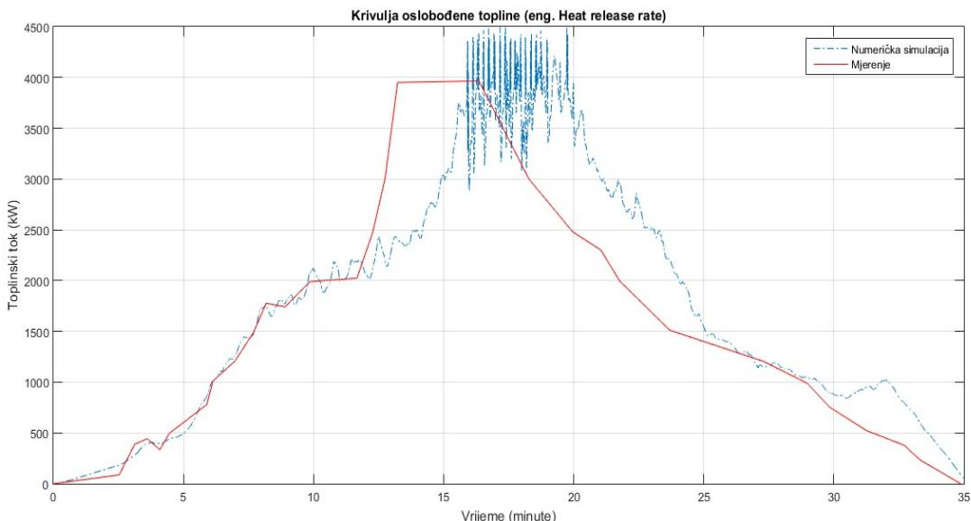
Slika 38. Usporedba rezultata simulacije s eksperimentalnim podacima
