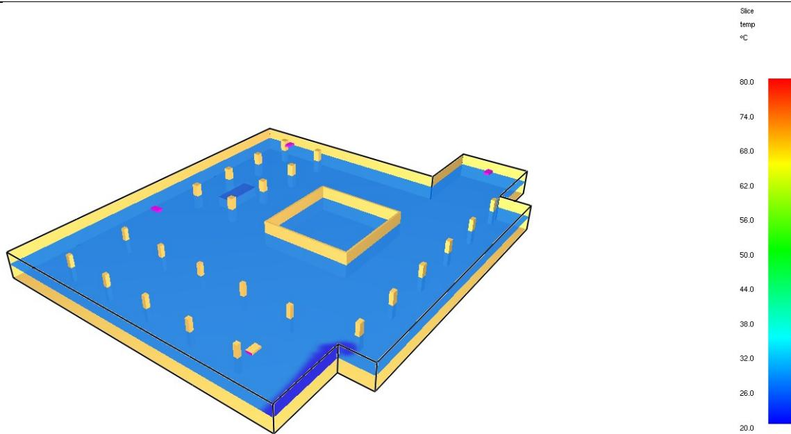
Slika 22. Konture temperature na visini 1.7 m nakon 1 minute
