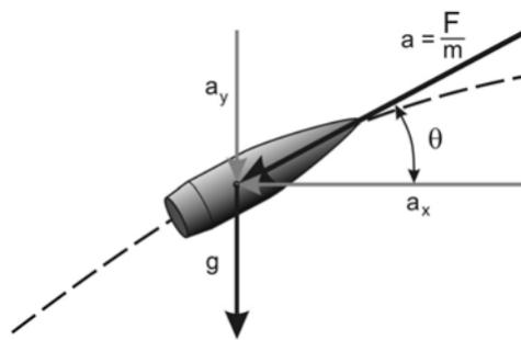
Slika 2.8. Komponente ubrzanja zrna u  $x$ - $y$  ravnini [2]
