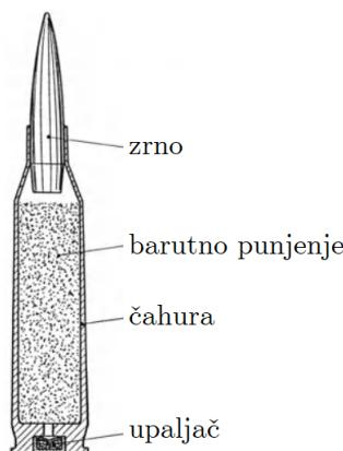
Slika 2.1. Uzdužni presjek metka i njegovi dijelovi [7]
