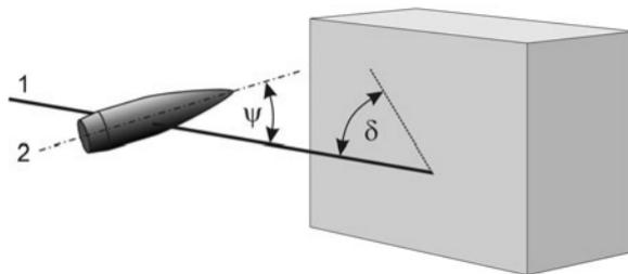
**Slika 2.7.** Kut napada i kut incidencije [2], (1) putanja težišta, (2) uzdužna osi zrna
