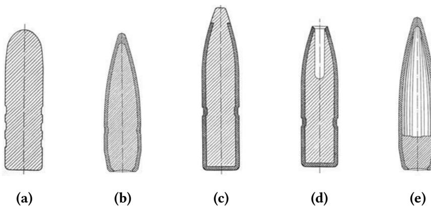
**Slika 2.3.** Presjeci zrna razlicitih konstrukcija [7]: a) jednodijelno zrno, b) potpuno presvučeno zrno, c) djelomično presvučeno zrno, d) djelomično presvučeno zrno sa šupljim vrhom, e) probojno zrno
