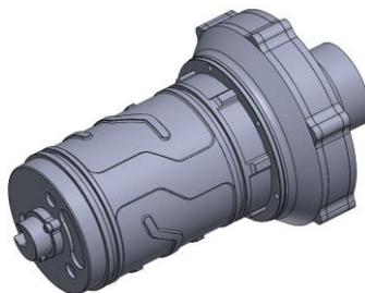
**Slika 7. CAD model sklopa motora i planetarnog reduktora**
