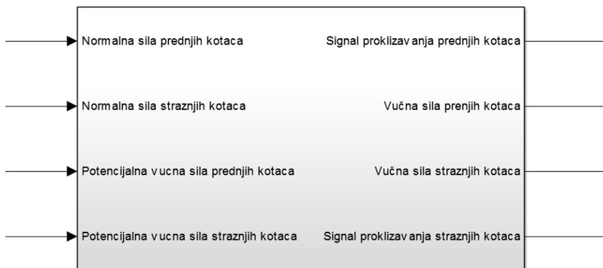
Slika 26. Reducirani blok proklizavanja guma (Simulink)
