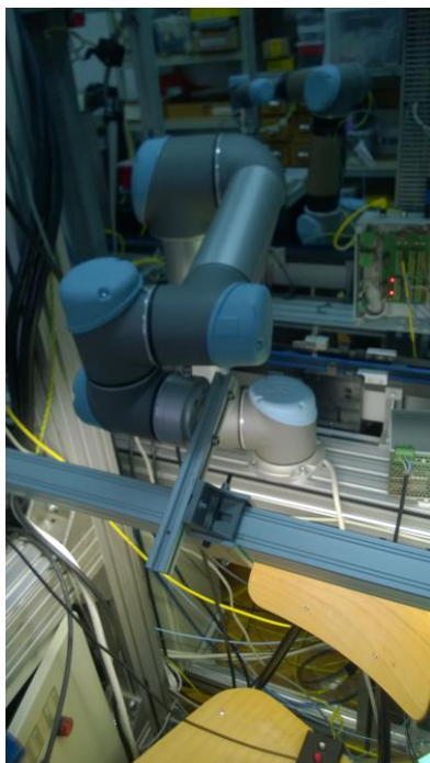
Slika 17: Robot UR5 s improviziranom hvataljkom za svjetlo
