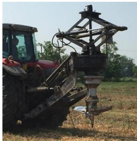
Slika 15. Groundwork razvrtavač
