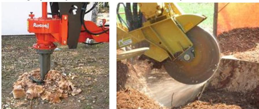
Slika 3. Stroj za razvrtavanje i drobilica
