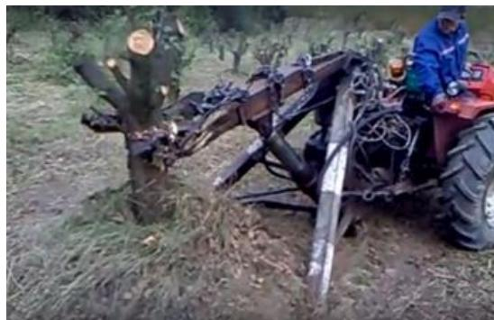
**Slika 22. Traktorski priključak izveden u domaćoj radnosti**
