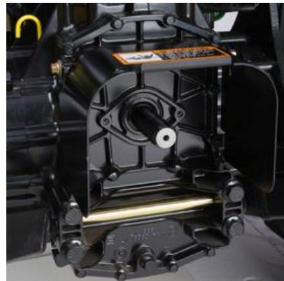
**Slika 8. Izlazno vratilo traktora**
