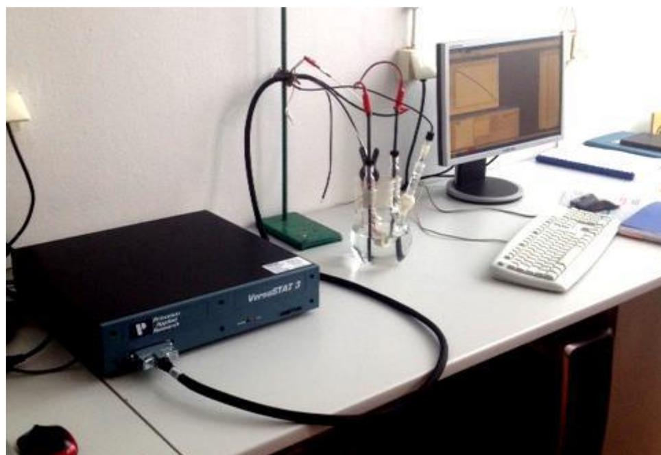
Slika 9. Uređaj za elektrokemijsko ispitivanje Potentiostat/Galvanostat, Model 273 EG&E.
