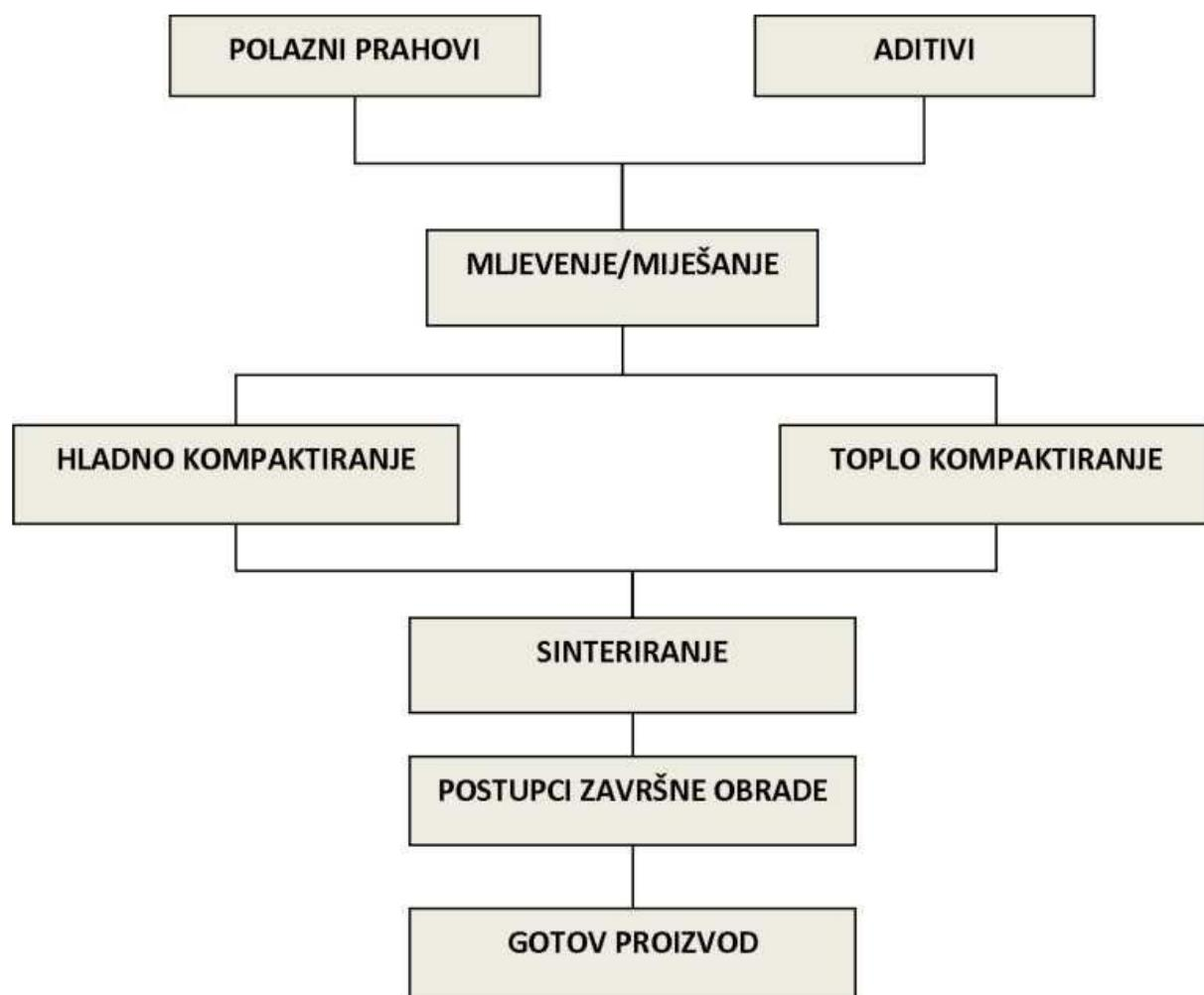
Slika 3. Tehnološke operacije konvencionalnih postupaka metalurgije praha [4].
