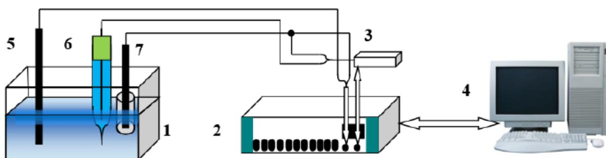
Slika 10. Shema osnovnog elektrokemijskog ispitivanja na Potentiostatu/Galvanostatu.
