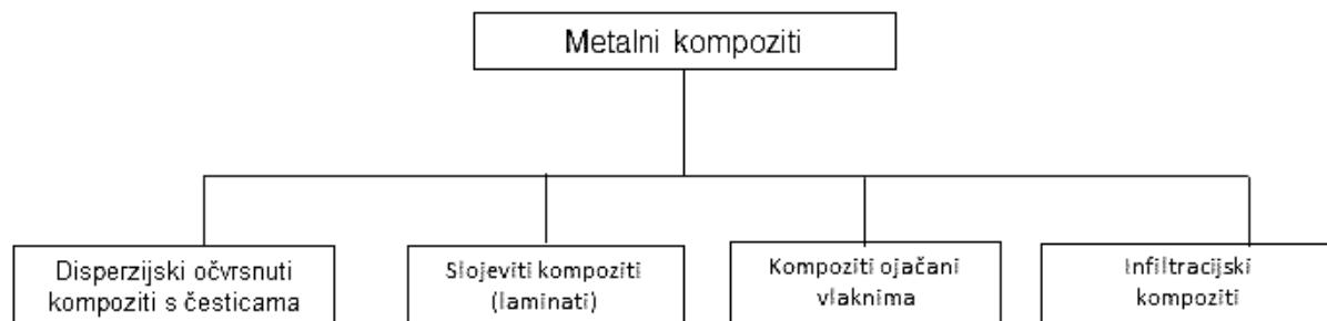
Slika 1. Podjela kompozita s metalnom matricom[2].
