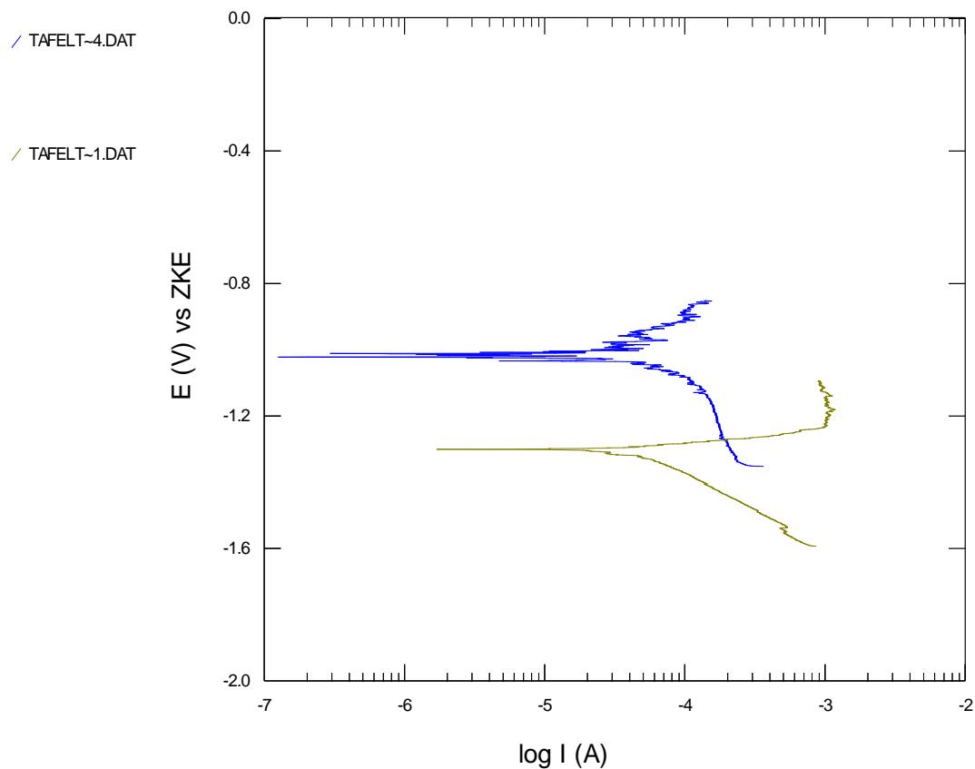
Slika 26. Tafel krivulja za TiMg5 i TiMg10 u ovisnosti potencijala i logaritma korozijske struje.
