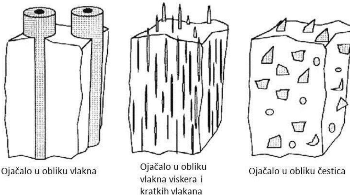
Slika 2. Osnovni oblici ojačala kompozita s metalnom matricom.
