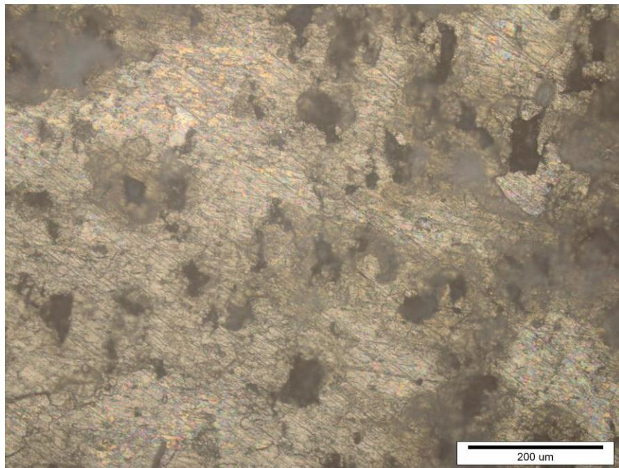
Slika 21. Mikrostruktura uzorka TiMg10I nakon korozije uz povećanje 200x.
