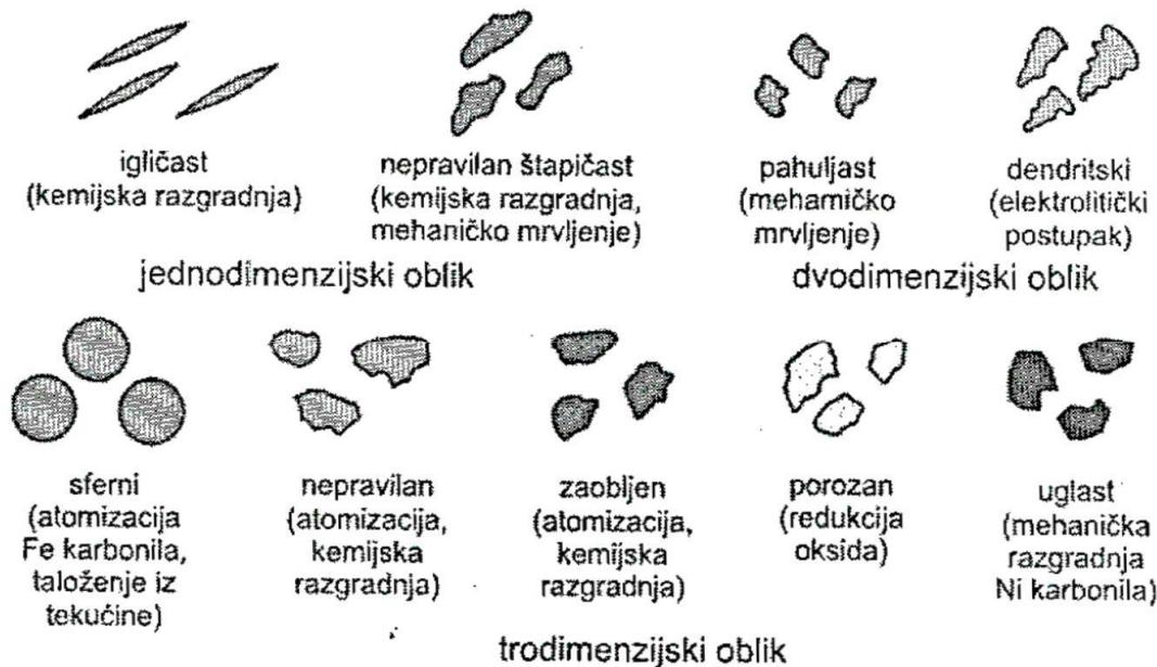
Slika 5. Oblici čestica praha i pripadajući proizvodni postupci [4].
