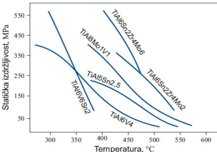
Slika 8. Statička izdržljivost nakon 150 sati opterećenja za odabране Ti-legure [4].
