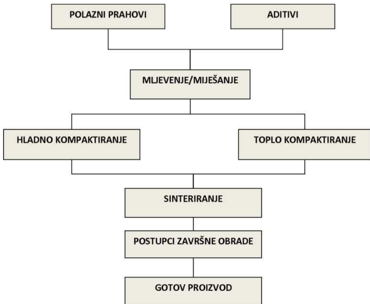
Slika 3. Tehnološke operacije konvencionalnih postupaka metalurgije praha [4].
