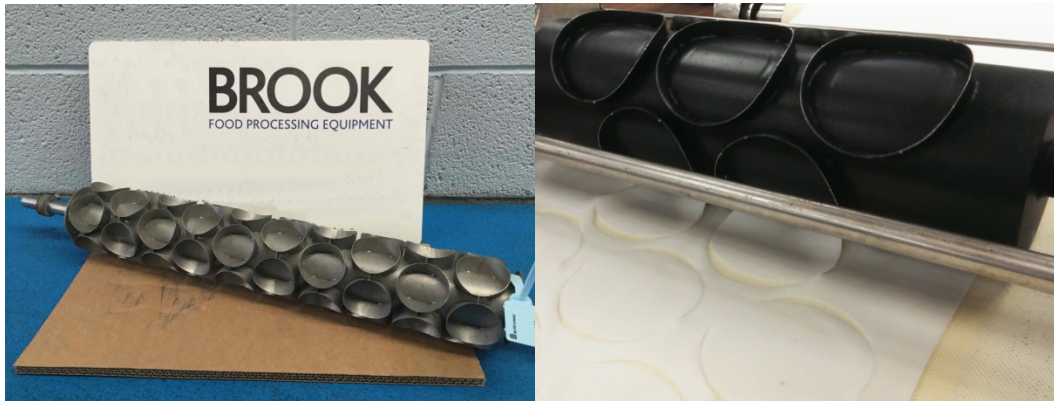
Sl. 5.2 Primjeri valjaka sa kružnim prstenima za utiskivanje kružnog oblika
