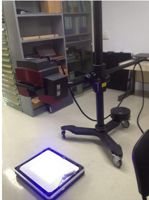
Slika 10. Kalibracija 3D skenera
