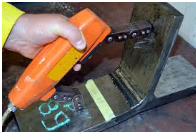
Slika 8: Ispitivanje magnetskim česticama [18]
