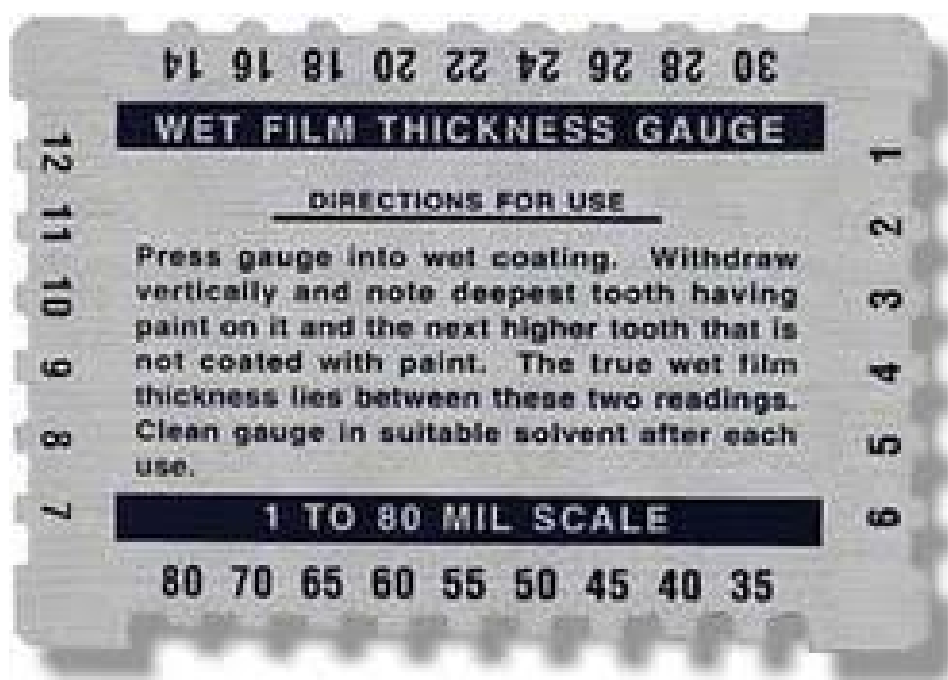
Slika 23: Naprava za očitavanje debljine mokrog filma [23]
