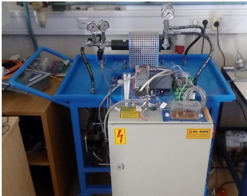
Slika 24 Eksperimentalni postav za regulaciju rotacijskog gibanja
