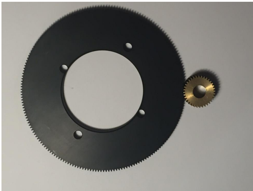
Slika 33. Par zupčanik nakon demontaže
