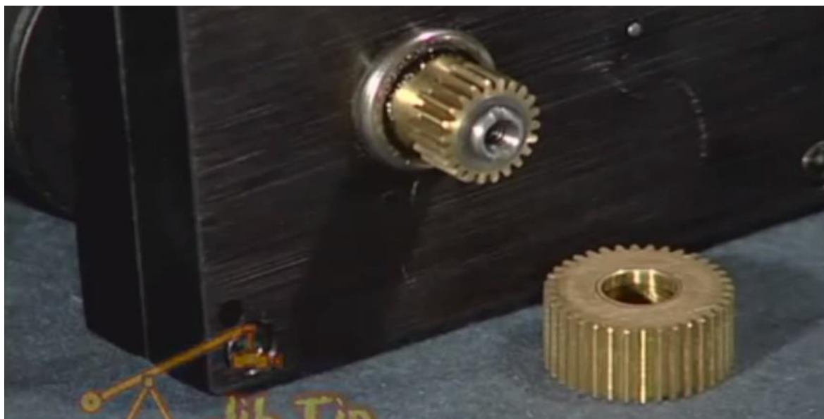
Slika 32. Pogonski zupčanik sa 22 i 36 zubi [25]
