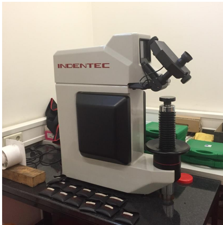
Slika 51. Tvrdomjer korišten za mjerenje tvrdoće
