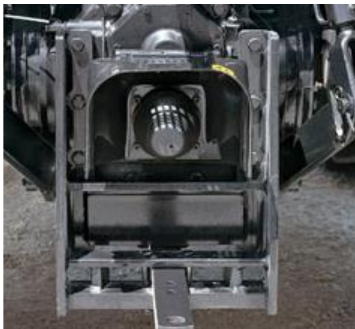
Slika 13. Izlazni priključak za radno vratilo na traktoru
