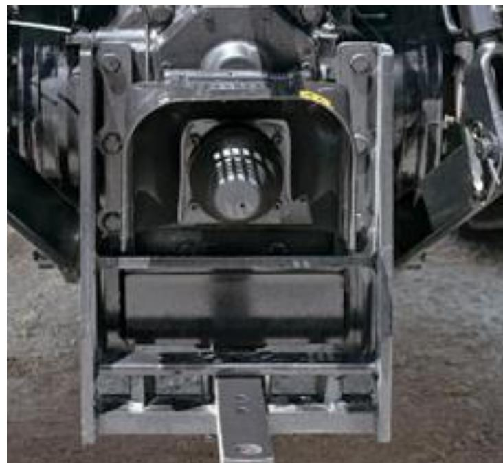
Slika 13. Izlazni priključak za radno vratilo na traktoru
