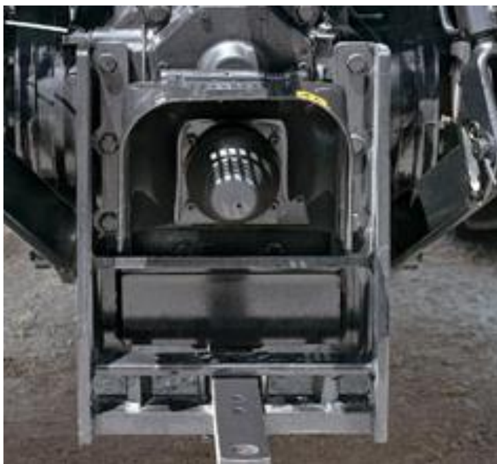
Slika 13. Izlazni priključak za radno vratilo na traktoru
