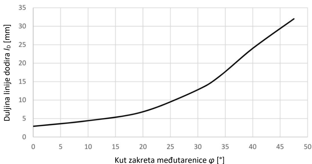
Slika 7. Grafički prikaz ovisnosti proračunske duljine linije dodira o kutu zakreta \varphi
