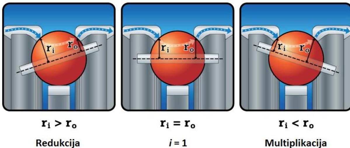
Slika 2. Promjena nagiba osi kugle, odnosno polumjera dodira
