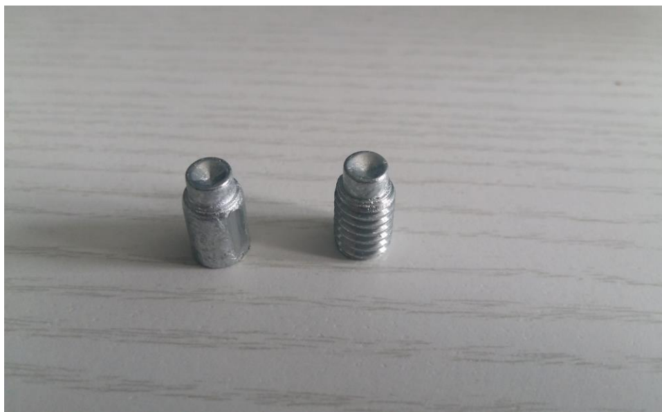
Slika 11. Dio C prije i nakon rezanja navoja
